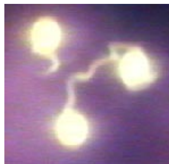
Figure 98 : Cliché à la caméra rapide des trois électrodes (fonctionnement à l'azote).
