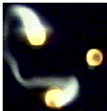
Figure 99 : Cliché à la caméra rapide des trois électrodes (fonctionnement à l'argon).
