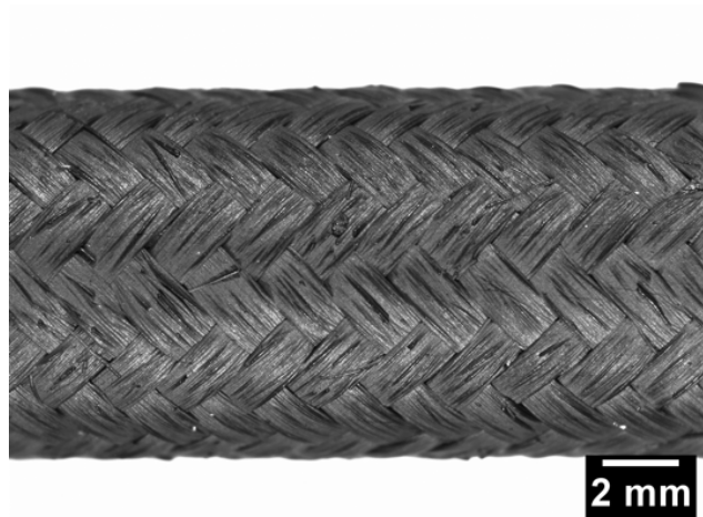
FIGURE II.8 – Image typique d'un tube utilisée pour la corrélation d'images. Dans cet exemple, le fond blanc permettrait de détecter les bords du tube par seuillage direct, mais le fond de l'image, en particulier en présence d'extensomètres, est souvent plus complexe.
