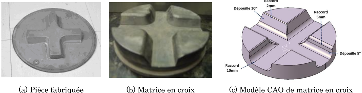
Figure 5.11. Pièce en forme de croix asymétrique
