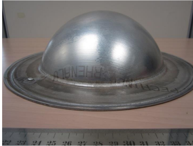
Figure 4.10. Pièce test obtenue en utilisant le démonstrateur superplastique du LAMPA
