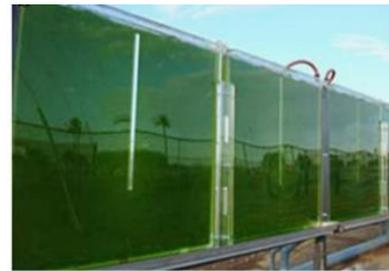
Figure I-12 : Photobioréacteur plan (Bitog et al., 2011)
