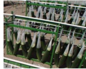
Figure I-16 : Système « Plastic bag » (Pulz, 2007)
