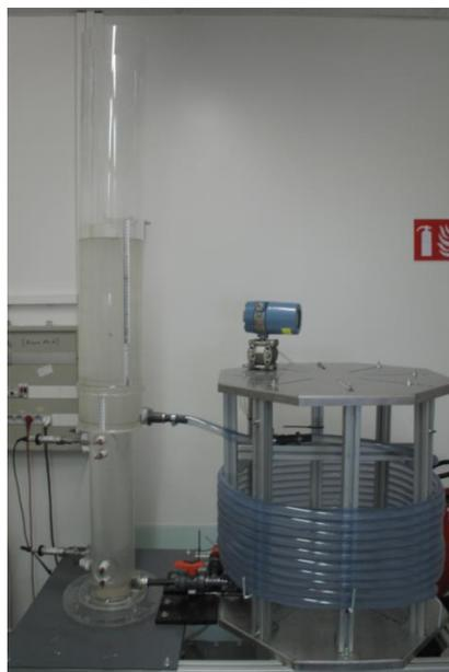
Figure I-17 : Photographie de l'airlift hélicoïdal utilisé par Rengel (Rengel, 2010)
