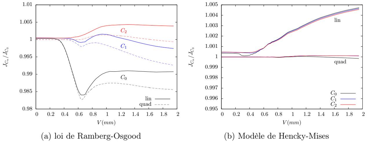
FIGURE 2.34 – Calcul numérique de  $J$  pour une éprouvette CT dont  $a/W = 0,7$
