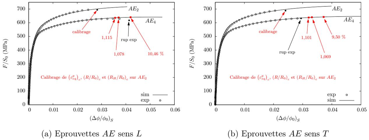
FIGURE 3.21 – Simulation de la rupture des éprouvettes  $AE_4$
