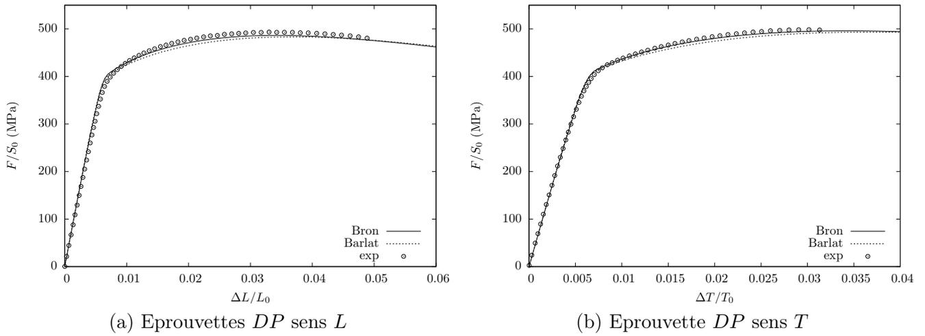
FIGURE 3.12 – Modélisation du comportement plastique des éprouvettes *DP*
