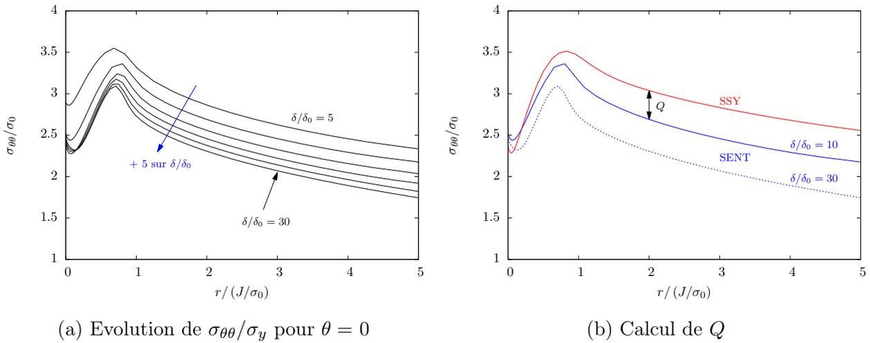
FIGURE 2.50 – Détermination de  $Q$  pour une éprouvette SENT avec  $a/W = 0,5$
