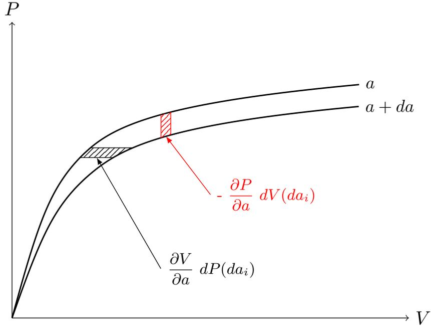
FIGURE 2.2 – Courbes  $P - V$  pour des longueurs de fissure voisines
