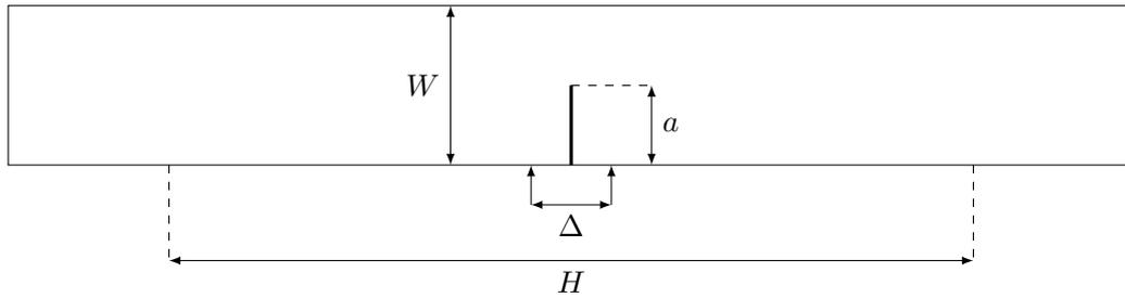
FIGURE 1.38 – Plan de définition d'une éprouvette SENT
