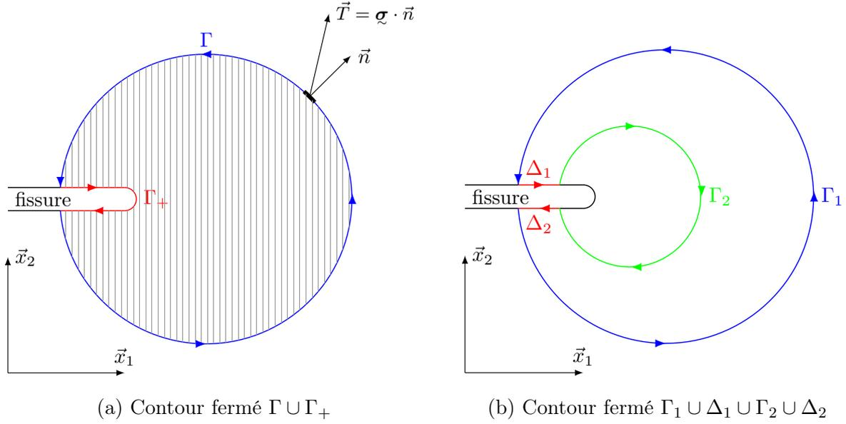
FIGURE 2.31 – Contours pour le calcul de l'intégrale  $J$
