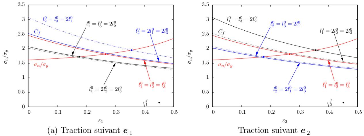
FIGURE 3.16 – Début de la coalescence pour des cellules de dimensions initiales différentes
