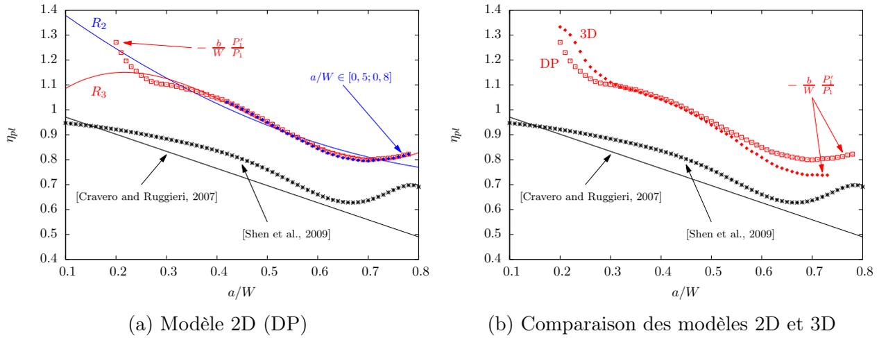
FIGURE 2.29 – Evolution de  $\eta_{pl}$  pour des éprouvettes SENT dont  $H/W = 10$
