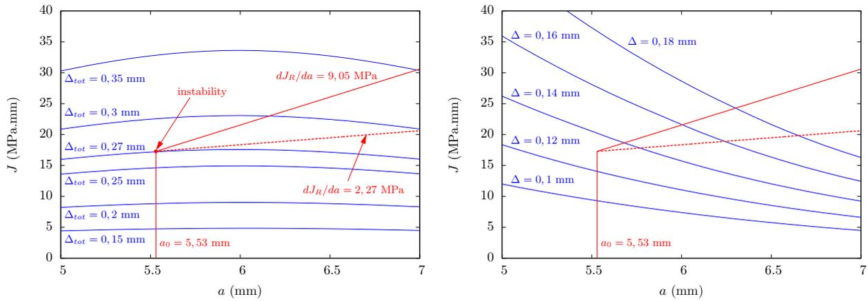
(a) raideur  $K_M = 152515 \text{ N/mm}$ (b) raideur  $K_M$  supposée infinie
