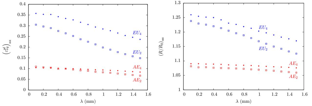
FIGURE 3.27 – Evolution de  $(\varepsilon_{eq}^{pl})_{aa}$  et de  $(R/R_0)_{aa}$  pour les éprouvettes *AE* et *EU*
