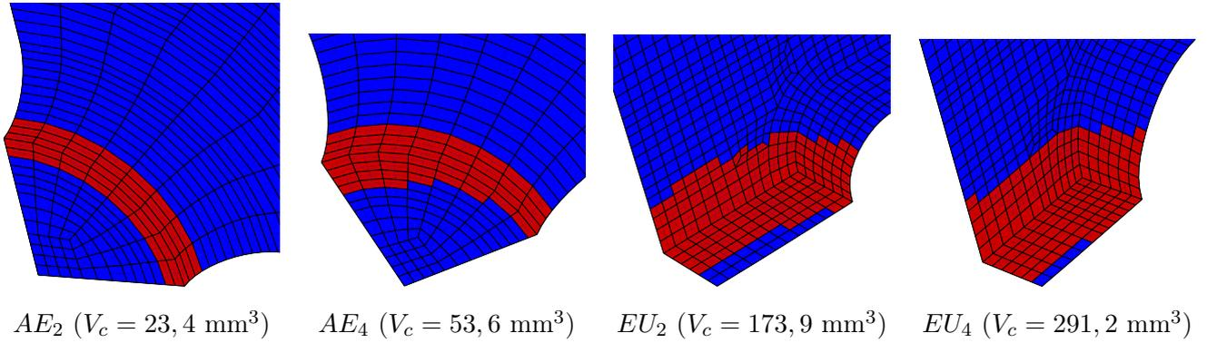
FIGURE 3.28 –  $V_c$  associé à  $(\varepsilon_{eq}^{pl})_s = 8\%$  pour les éprouvettes  $AE$  et  $EU$
