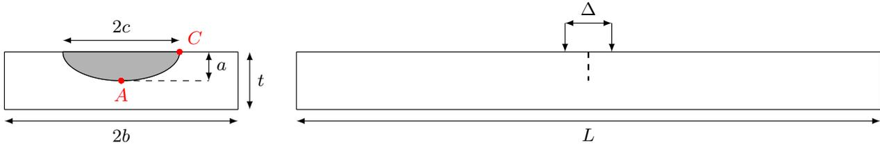
FIGURE 2.61 – Géométrie d'une éprouvette SCT
