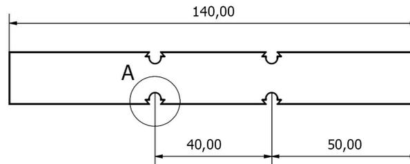
Eprouvette bi-entallée  $EU_2$ FIGURE 1.51 – Plan de définition des éprouvettes bi-entallées  $AE_2$  et  $EU_2$
