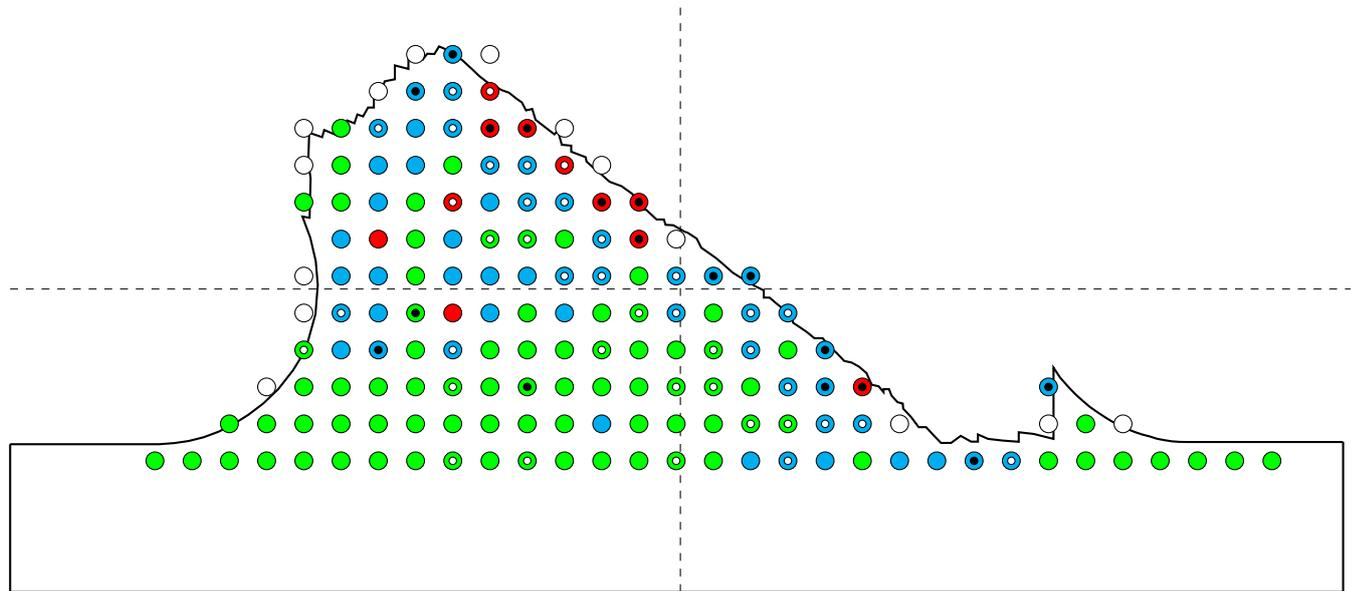
$AE_2$  sens L
