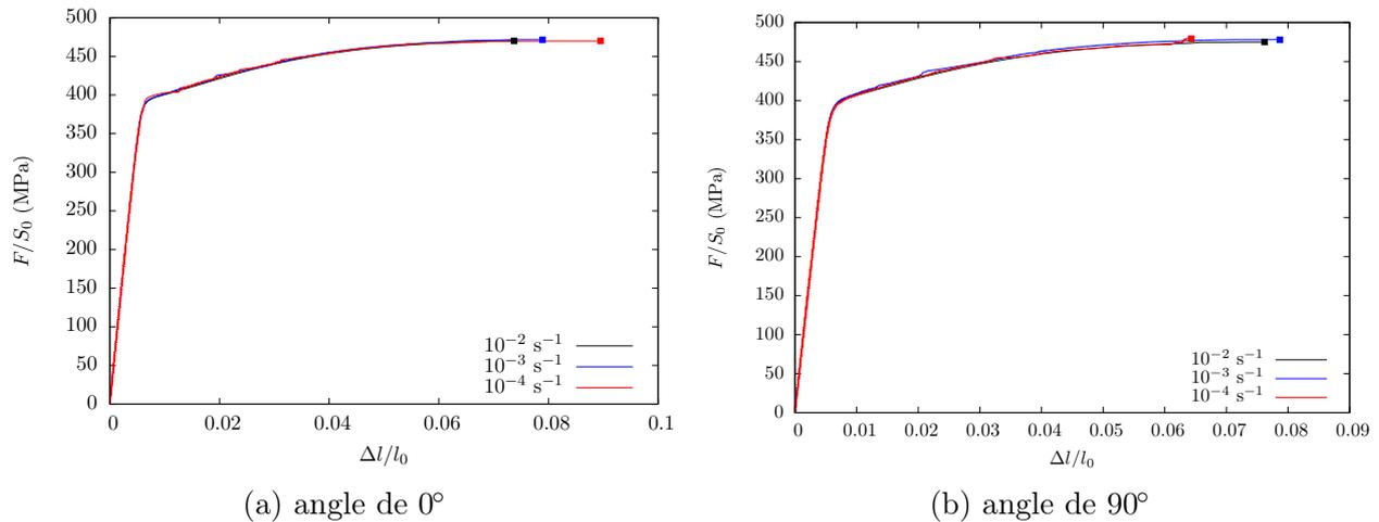
FIGURE 1.6 – Courbes contrainte-déformation pour les éprouvettes  $D_{10}$  prélevées selon  $L$  et  $T$
