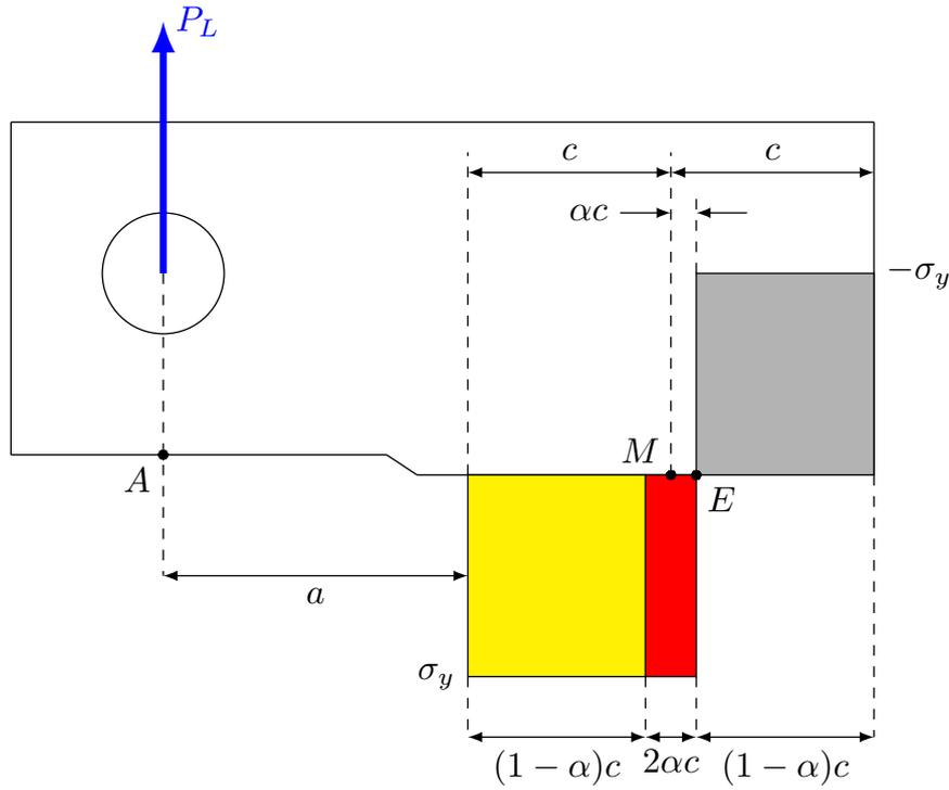
FIGURE 2.1 – Flexion et traction du ligament
