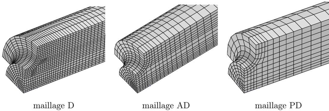
FIGURE 3.8 – Les différentes densités de maillage pour l'éprouvette  $AE_2$
