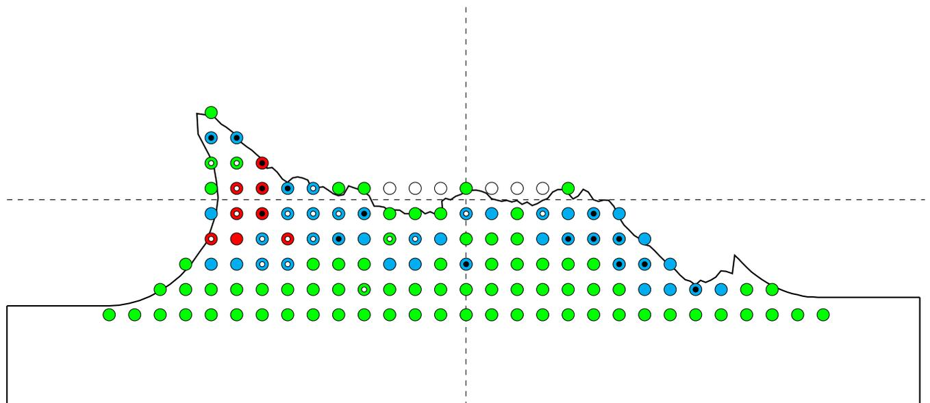
$AE_2$  sens TFIGURE D.1 – Cartographie de la porosité pour les éprouvettes  $AE_2$
