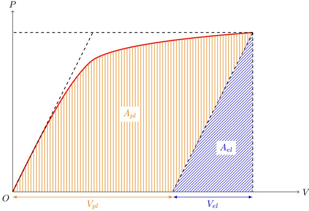
FIGURE 1.23 – Courbe  $P$ - $V$  pour un essai sur éprouvette CT
