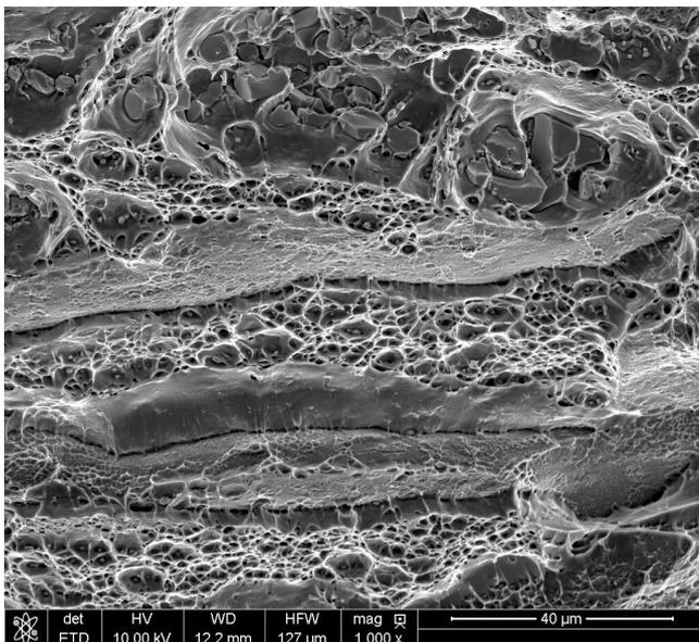
*AE*<sub>2</sub> sens *D* (1000x)
