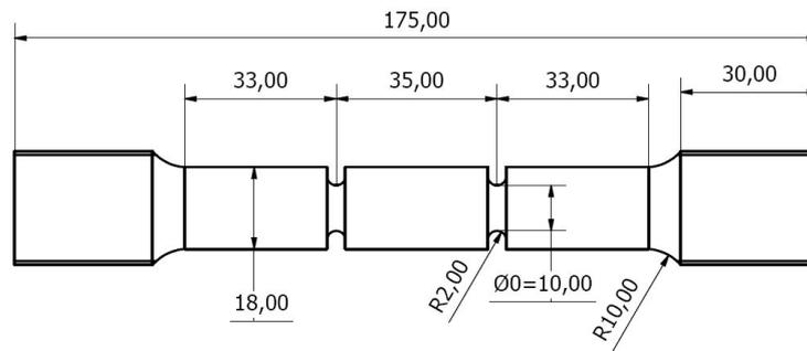
Eprouvette bi-entallée  $AE_2$
