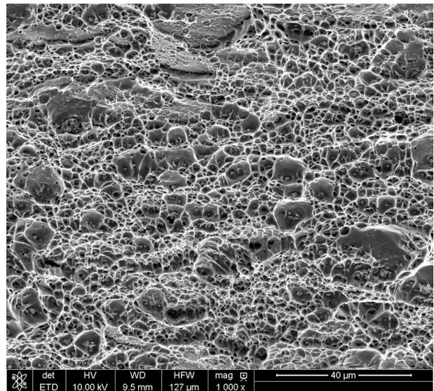
*AE<sub>2</sub> sens T (1000x)*FIGURE 1.49 – Observations au MEB des faciès de ruptures des éprouvettes *DP*
