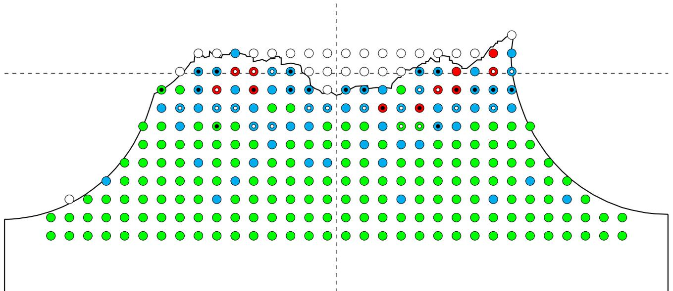
$AE_2$  sens TFIGURE D.2 – Cartographie de la porosité pour les éprouvettes  $AE_4$
