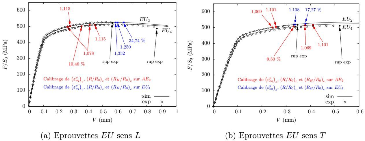
FIGURE 3.24 – Simulation de la rupture des éprouvettes  $EU$
