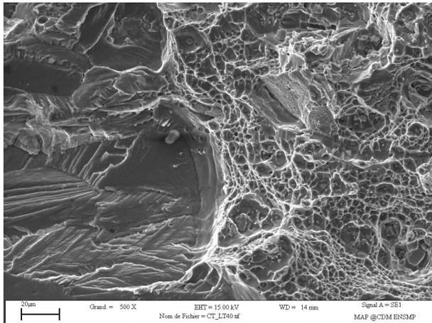
(a) Eprouvette CT10  $L-T$  (500x)
