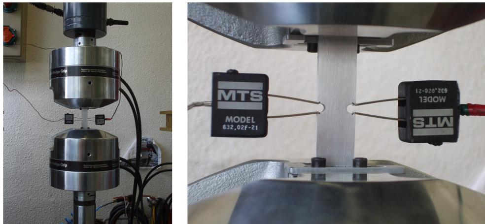
FIGURE 1.13 – Mesure des déplacements d'ouverture des entailles pour les éprouvettes EU<sub>4</sub> et EU<sub>2</sub>
