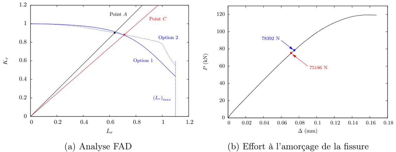
FIGURE 2.62 – Prédiction de l'amorçage pour l'éprouvette SCT n° 1
