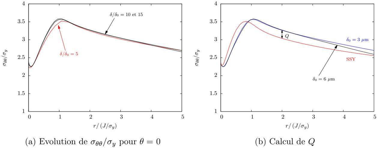
FIGURE 2.49 – Détermination de  $Q$  pour l'éprouvette CT10 avec  $a/W = 0,5$
