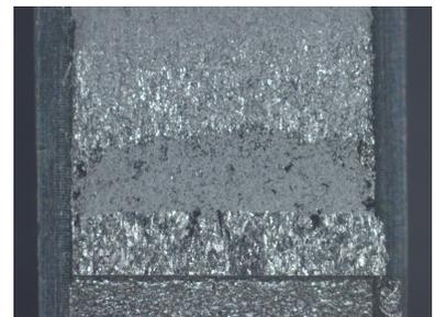
Propagation par déchirure ductile
