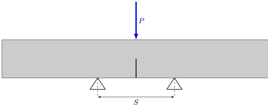
FIGURE 1.39 – Préfissuration en flexion 3 points d'une éprouvette SENT
