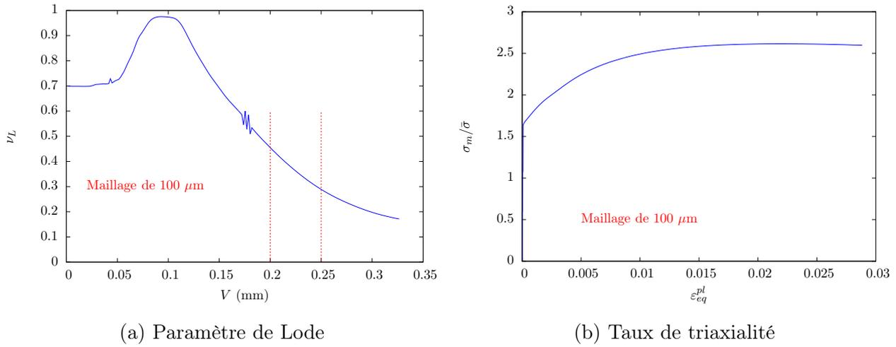
FIGURE 3.40 – Evolution du paramètre de Lode et du taux de triaxialité pour les éprouvettes CT10 de type  $L - T$
