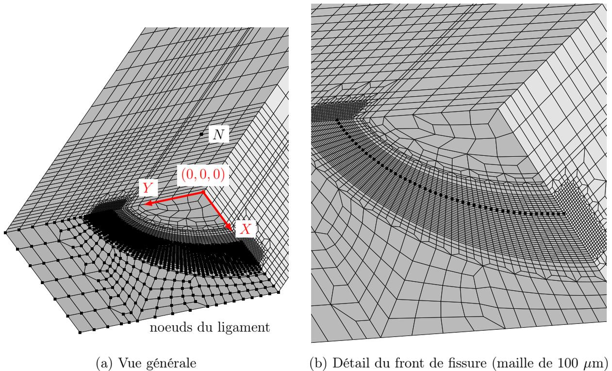
FIGURE 3.43 – Modélisation des éprouvettes SCT
