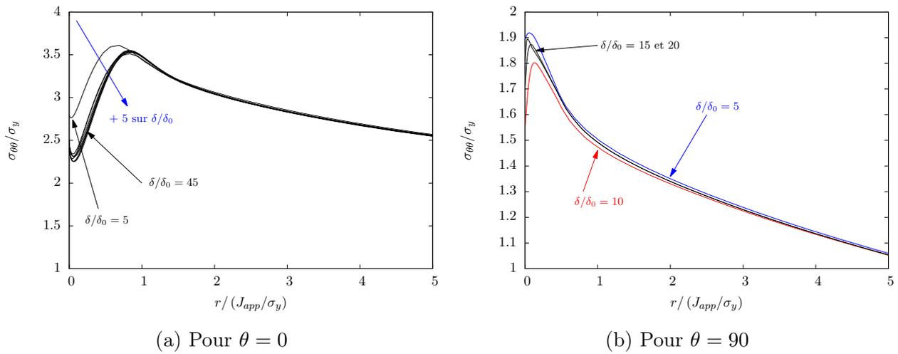
FIGURE 2.46 – Evolution de  $\sigma_{\theta\theta}/\sigma_y$  en fonction de  $r/(J_{app}/\sigma_y)$
