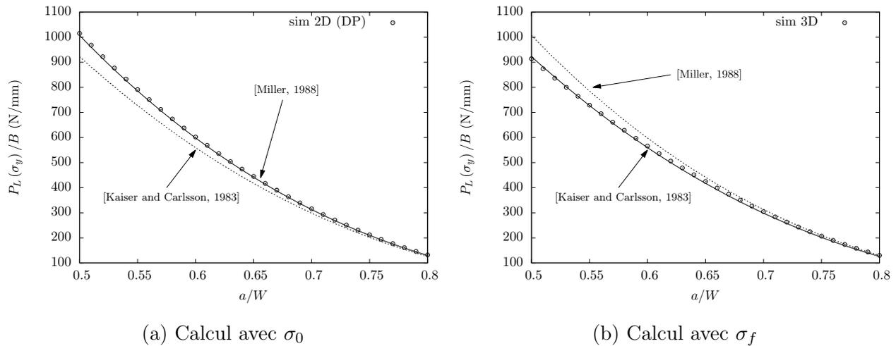
FIGURE 2.53 – Comparaison des valeurs de  $P_L$  obtenues par simulation avec celles issues de la littérature
