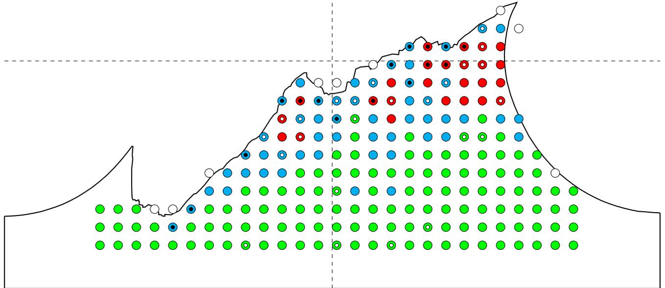
$AE_2$  sens L
