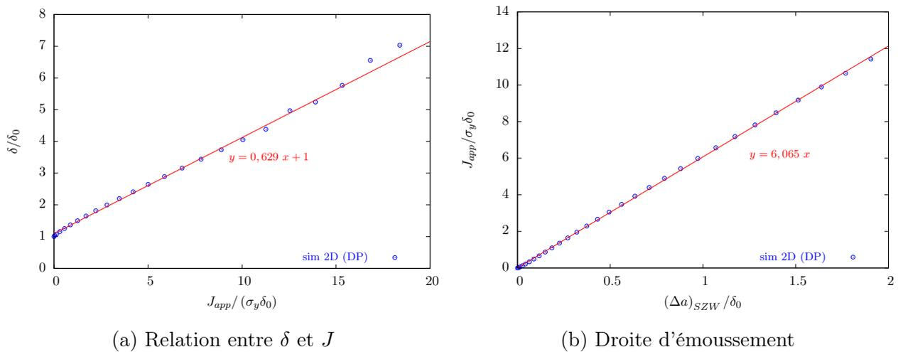
FIGURE 2.47 – Evolution du CTOD et de l'émoussement en fonction de  $J$
