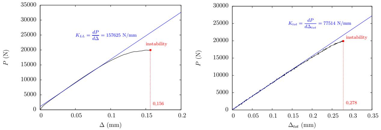
FIGURE 2.65 – Détermination de  $K_{LL}$  et de  $K_{tot}$  à partir de l'éprouvette SENT n° 1
