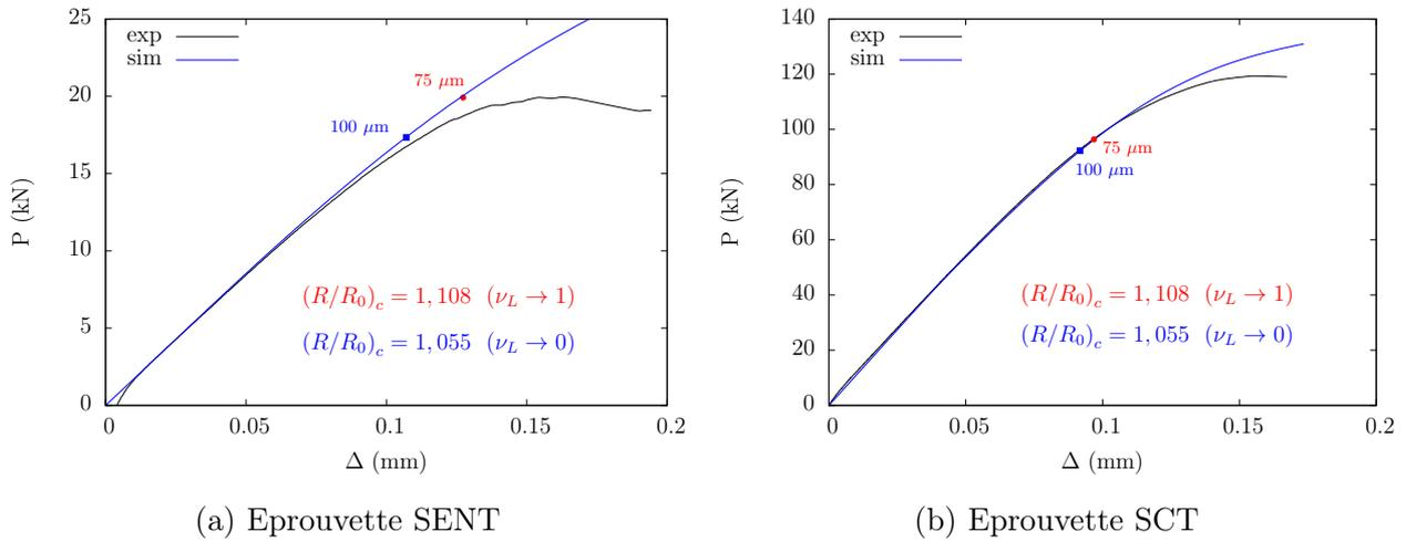
FIGURE 3.44 – Prédiction de la rupture des éprouvettes SSENT et SCT
