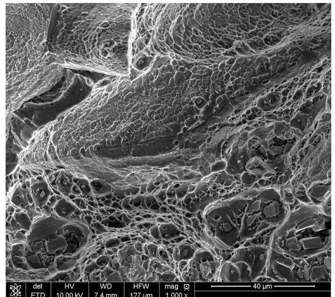
*AE*<sub>4</sub> sens *D* (1000x)FIGURE B.1 – Observation au MEB des faciès de rupture des éprouvettes *AE* pour le sens *D*
