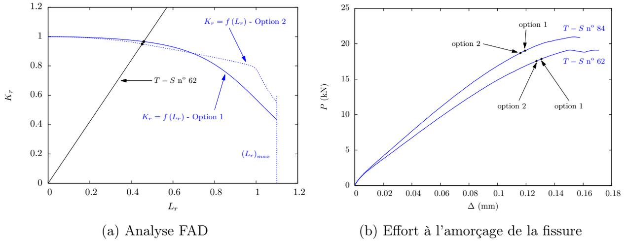
FIGURE 2.60 – Prédiction de l'amorçage pour les éprouvettes  $T - S$  n° 062 et  $T - S$  n° 084
