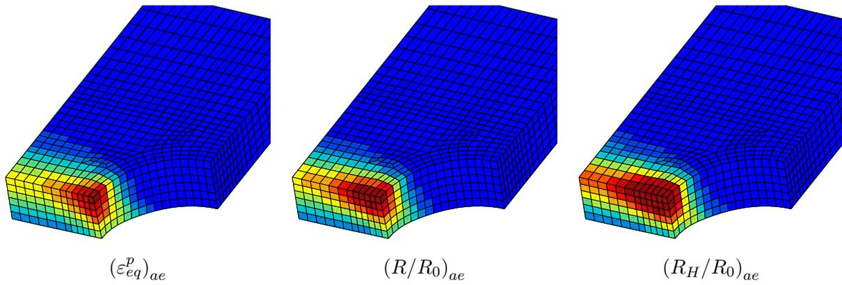
FIGURE 3.30 – Cartographie des différents critères à l’instant de la rupture de l’éprouvette  $EU_4$
