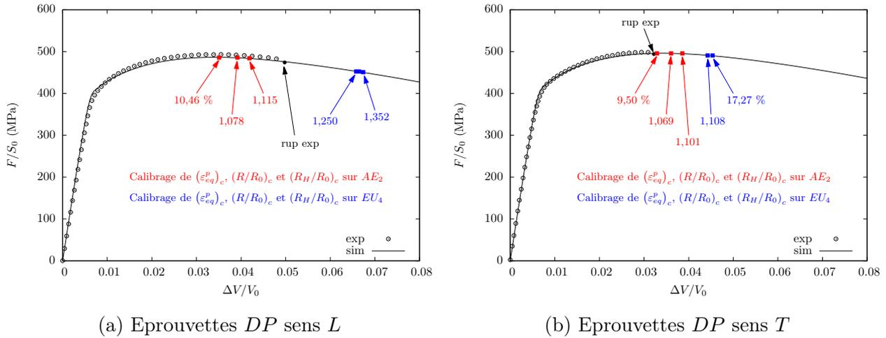
FIGURE 3.33 – Simulation de la rupture des épreuves  $DP$
