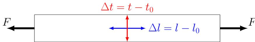
FIGURE 1.9 – Définition des déformations utilisées pour calculer  $L_k$
