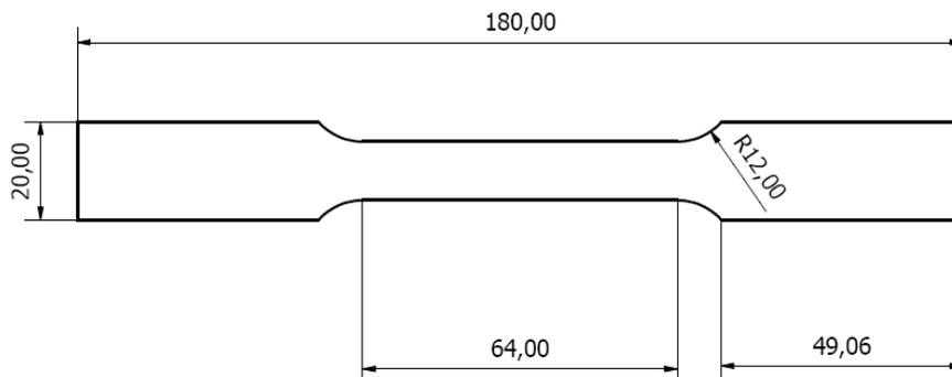
FIGURE 1.7 – Plan de définition des éprouvettes  $TR_{12}$
