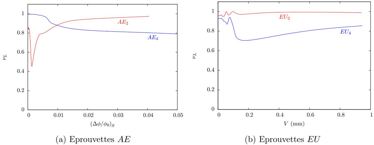
(a) Éprouvettes  $AE$ (b) Éprouvettes  $EU$ FIGURE 3.26 – Évolution du paramètre de Lode  $\nu_L$  au niveau de la zone critique associée à  $R/R_0$  pour les éprouvettes  $AE$  et  $EU$
