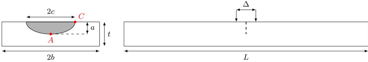
FIGURE 1.41 – Dimensions caractéristiques de la géométrie d'une éprouvette SCT
