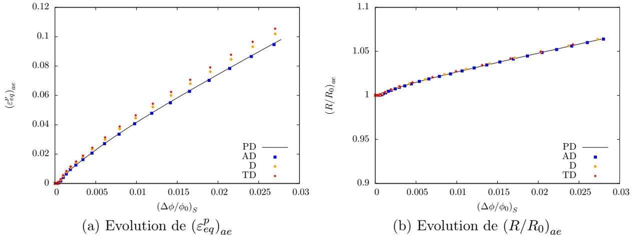
FIGURE 3.18 – Evolution des valeurs maximales de  $(\varepsilon_{eq}^p)_{ae}$  et  $(R/R_0)_{ae}$  pour les différents maillages
