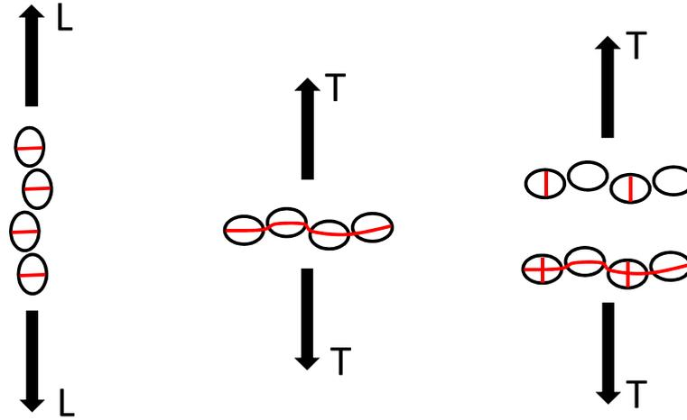
FIGURE 3.59 – Schéma des micromécanismes justifiant une germination différente selon  $L$  et  $T$
