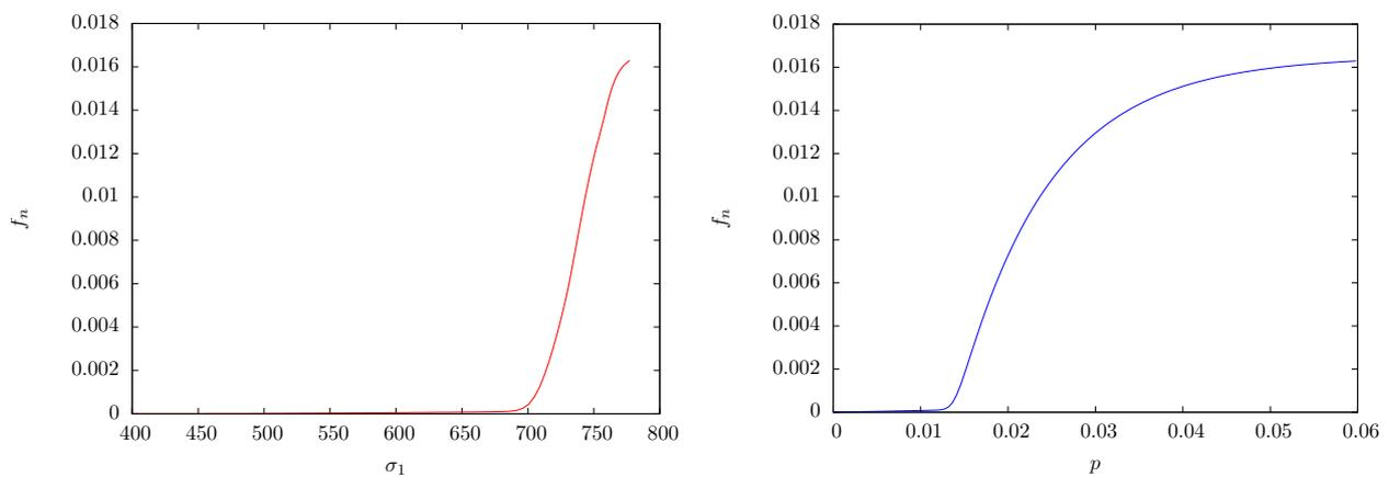
(a)  $f_n$  en fonction de  $\sigma_1$ (b)  $f_n$  en fonction de  $p$ FIGURE 3.65 – Evolution de la porosité  $f_n$  lorsque la germination est contrôlée par  $\sigma_1$  et  $p$
