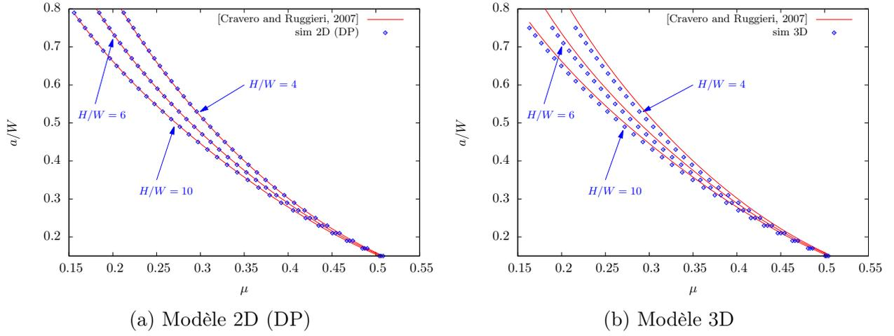
FIGURE 2.23 – Evolution de  $a/W$  en fonction de  $\mu$
