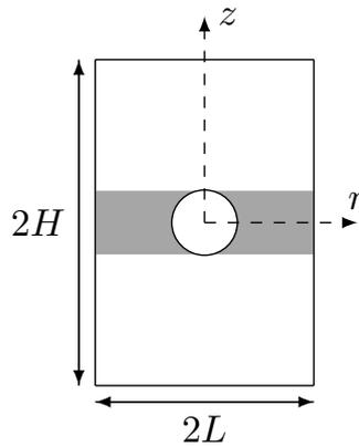
FIGURE 3.14 – Cellule cylindrique centrée sur une cavité sphérique
