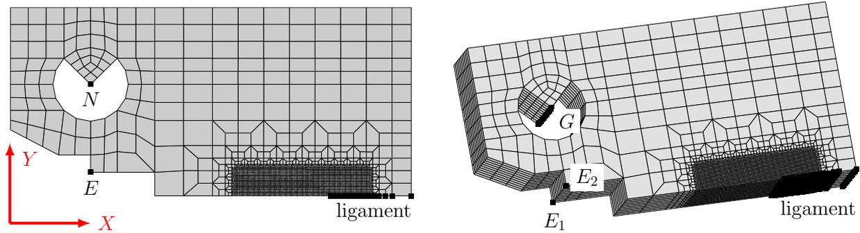
FIGURE 2.8 – Maillage 2D et 3D de l'éprouvette CT10
