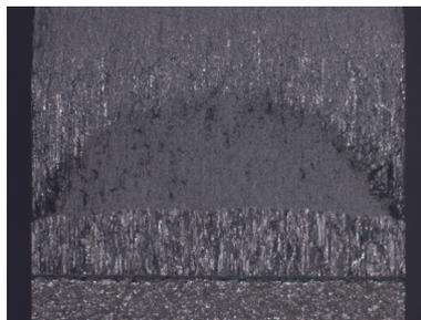
Propagation par déchirure ductile
