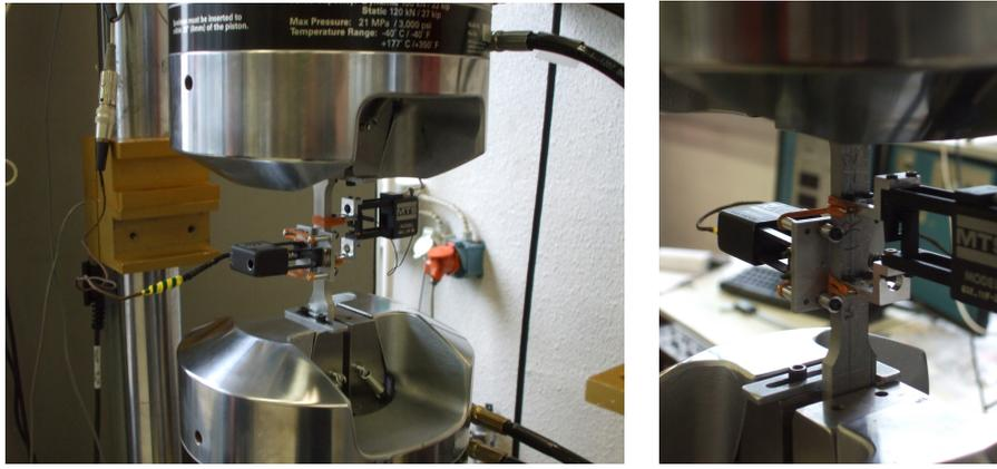
FIGURE 1.8 – Mesure des déformations longitudinale et transverse des éprouvettes  $TR_{12}$
