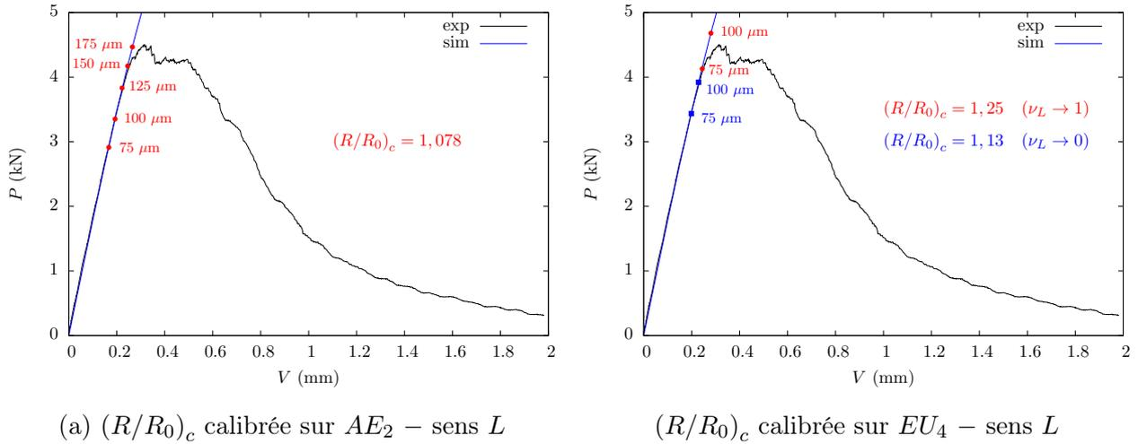
FIGURE 3.41 – Calibrage de la taille de maille des éprouvettes CT10 de type  $L - T$
