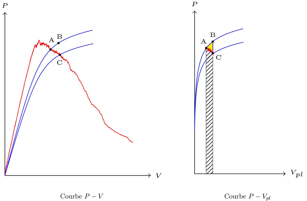
FIGURE 2.6 – Effort en fonction du déplacement pour une éprouvette fissurée
