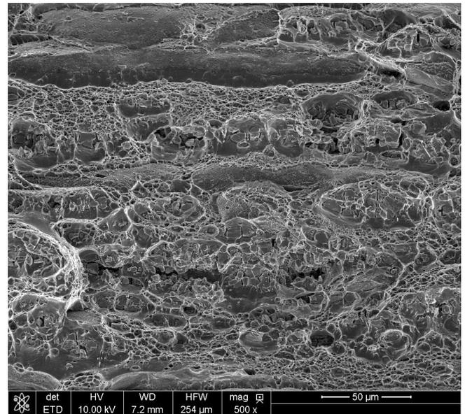
$AE_4$  sens T (500x)FIGURE C.1 – Comparaison de la taille des cupules entre les éprouvettes  $EU_4$  et  $AE_4$
