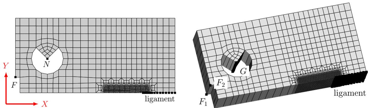
FIGURE 2.9 – Maillage 2D et 3D de l'éprouvette CT20
