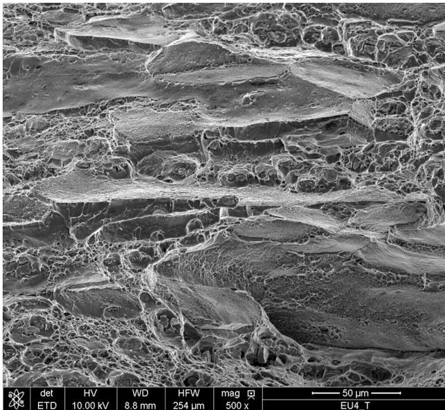
$EU_4$  sens T (500x)
