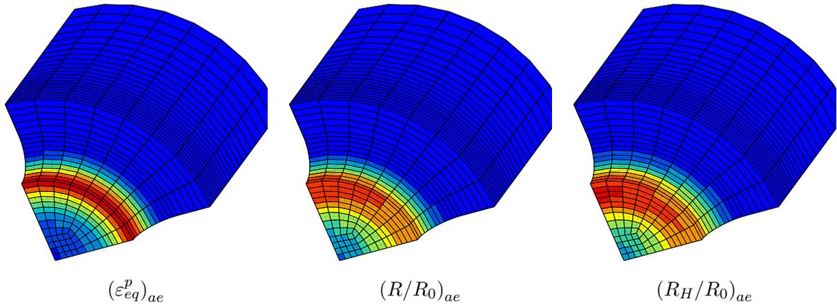
FIGURE 3.19 – Cartographie des différents critères à l’instant de la rupture de l’éprouvette  $AE_2$
