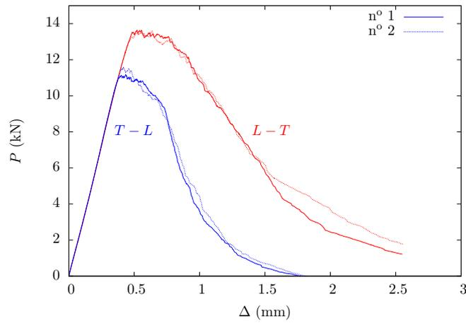
FIGURE 1.27 – Courbe  $P - \Delta$  des éprouvettes CT20
