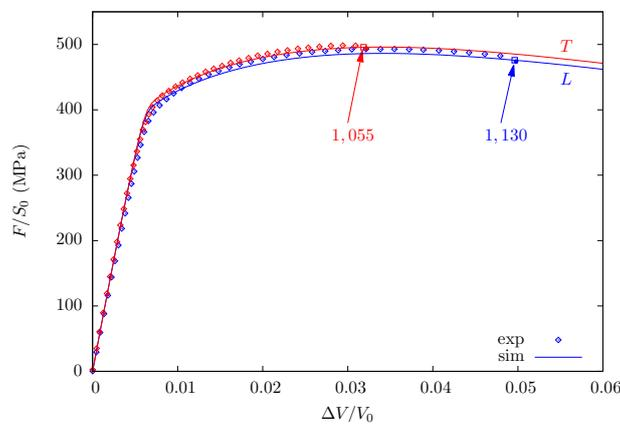
FIGURE 3.34 – Calibration de  $(R/R_0)_c$  afin de simuler la rupture des épreuves  $DP$
