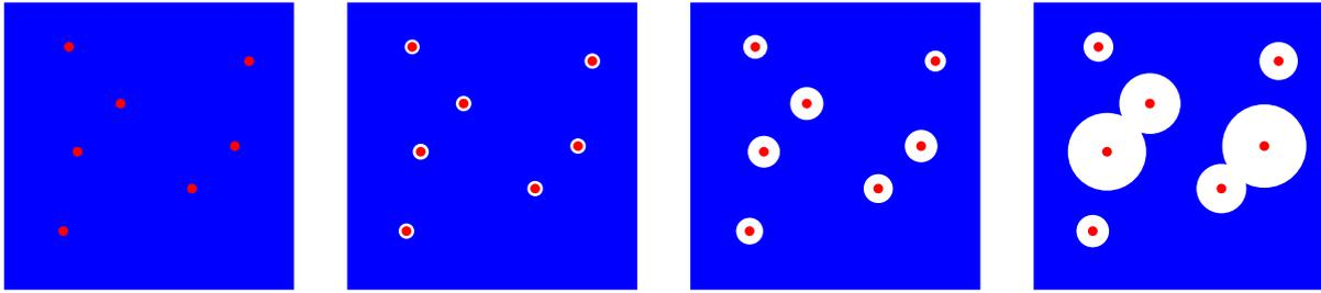
FIGURE 1.44 – Micromécanisme de la rupture ductile
