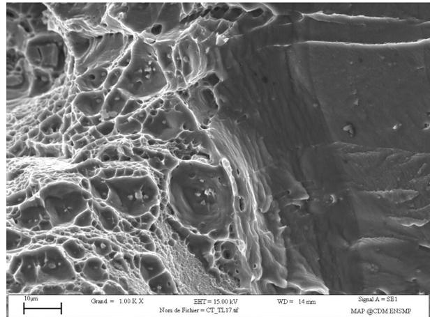
(b) Eprouvette CT10  $T-L$  (1000x)FIGURE 1.37 – Vue de la zone d'émoussetment pour des éprouvettes CT10 de type  $L-T$  et  $T-L$
