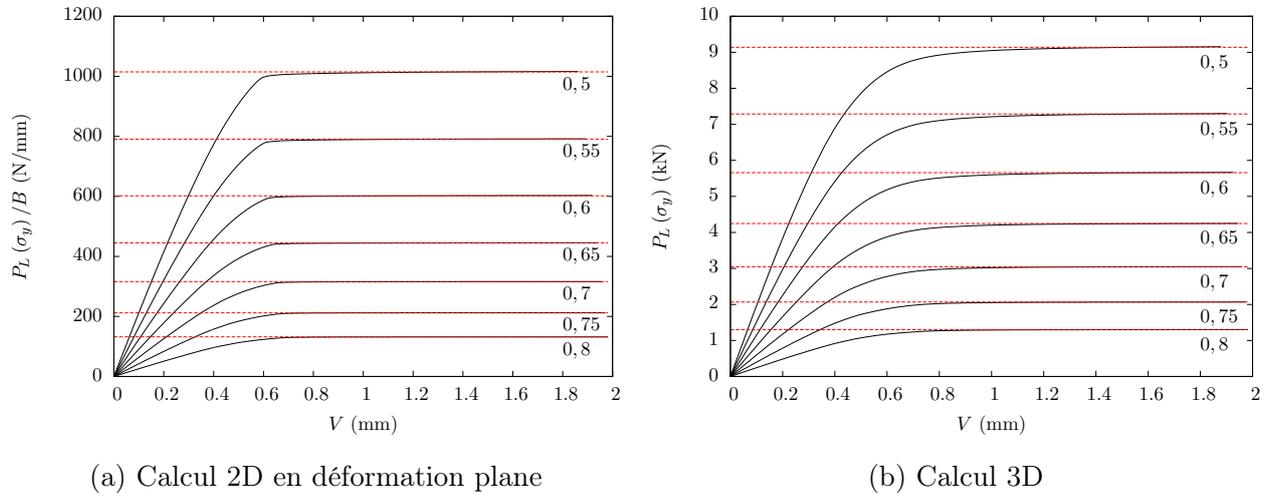
FIGURE 2.52 – Effort  $P_L$  pour les éprouvettes CT10 pour différents ratios  $a/W$
