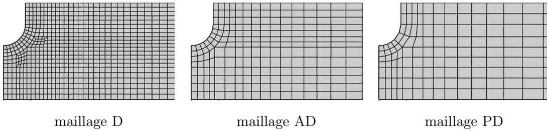
FIGURE 3.4 – Les différentes densités de maillage pour l'éprouvette  $EU_2$
