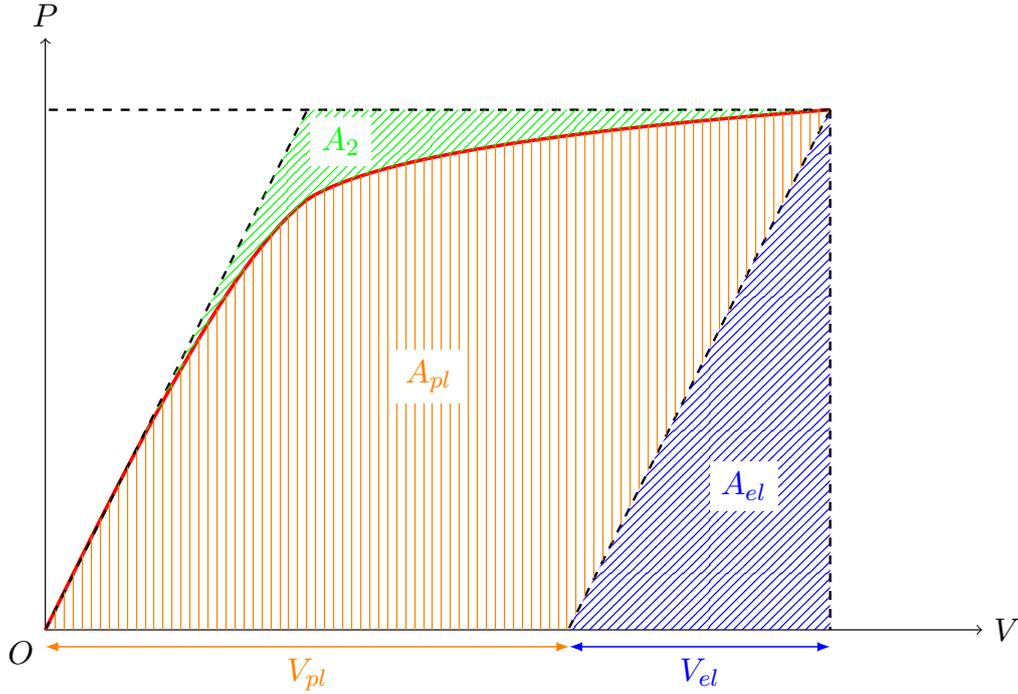
FIGURE 2.4 – Courbe  $P - V$  pour une éprouvette CT
