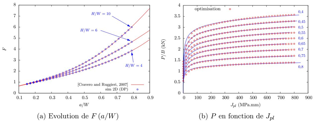
FIGURE 2.41 – Résultats du calcul de  $J$  pour les éprouvettes SENT
