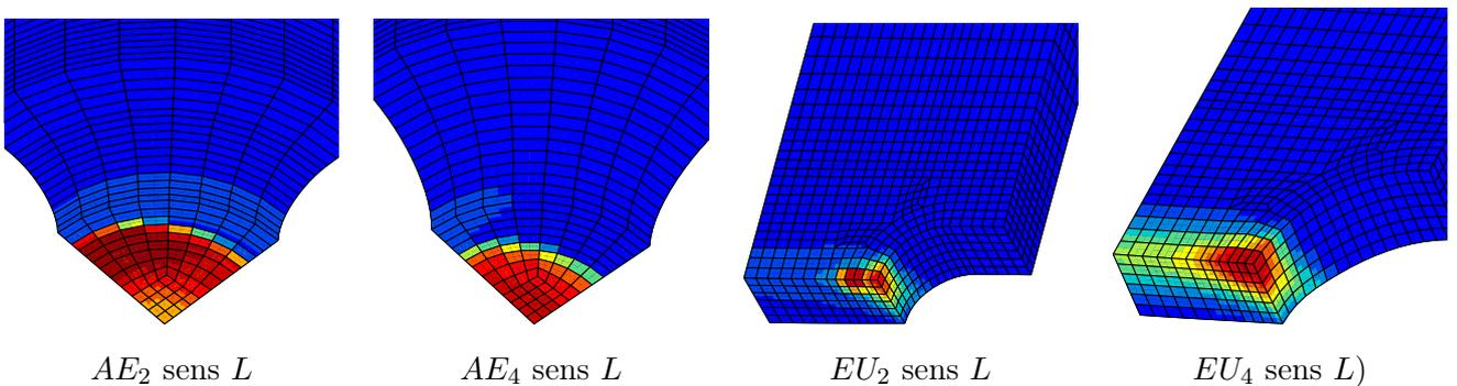
FIGURE 3.57 – Répartition de la porosité à l’instant de la rupture pour les éprouvettes  $AE$  et  $EU$  prélevées selon  $L$  dans le cas d’une germination contrôlée par  $A_n$  et  $C_n$
