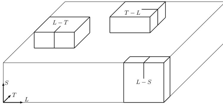
FIGURE 1.25 – Sens de prélèvement des éprouvettes CT
