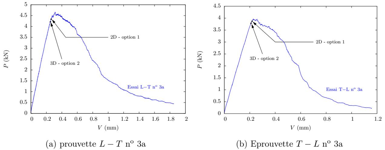
FIGURE 2.55 – Pr evision de l’amorage pour les  prouvettes  $L - T$  n° 3a et  $T - L$  n° 3a
