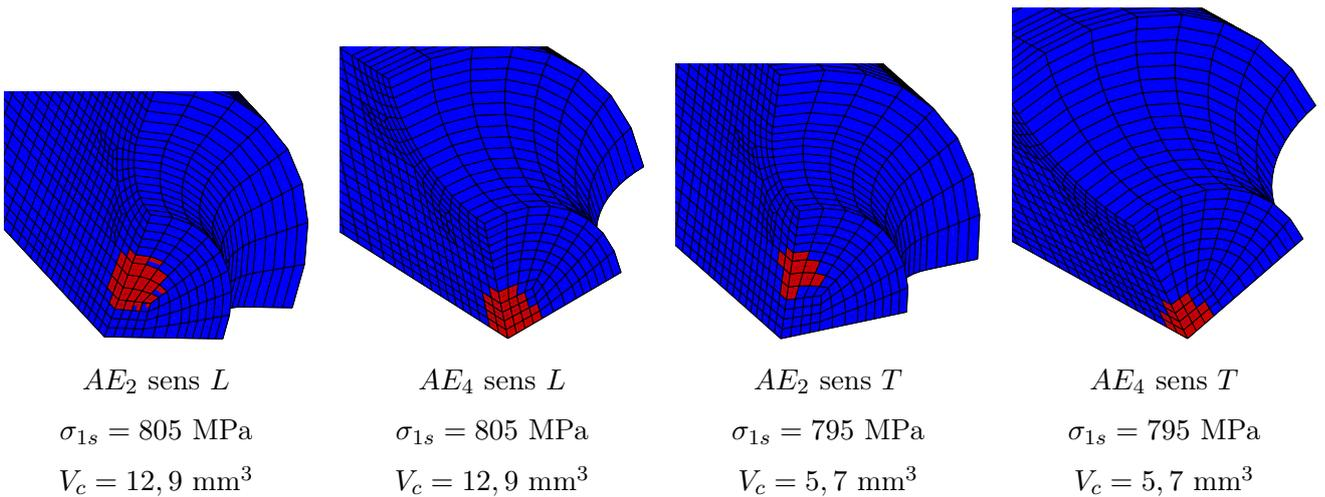
FIGURE 3.38 –  $V_c$  associé à  $\sigma_{1s}$  pour la simulation de la rupture des éprouvettes AE
