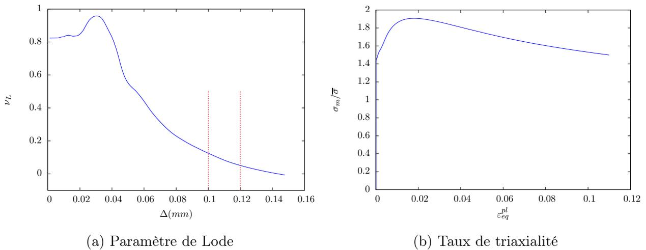
FIGURE 3.45 – Evolution du paramètre de Lode et du taux de triaxialité pour les éprouvettes SSENT
