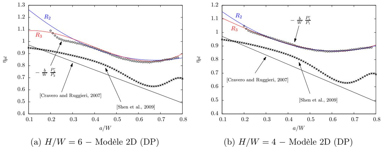
FIGURE 2.30 – Evolution de  $\eta_{pl}$  pour des éprouvettes SENT dont  $H/W = 6$  et  $H/W = 4$
