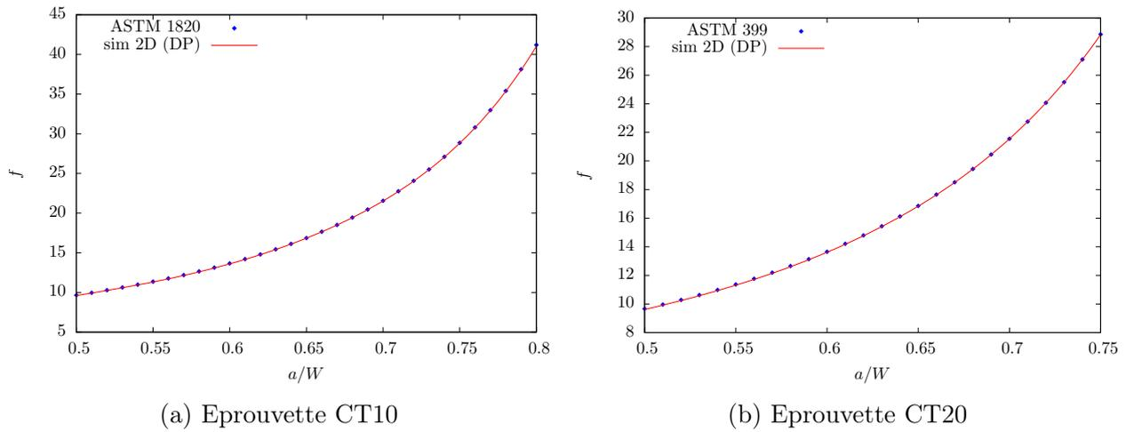
FIGURE 2.37 – Comparaison de  $f(a/W)$  issue du calcul avec la spécification des normes ASTM
