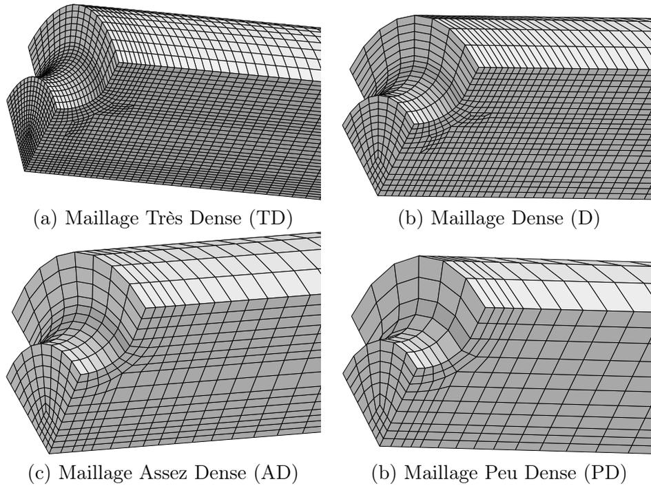
FIGURE 3.17 – Les différents maillages de l'éprouvette  $AE_2$
