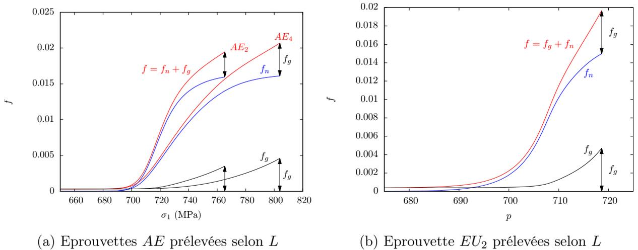
FIGURE 3.54 – Décomposition de  $f$  en  $f_n$  et  $f_g$  pour la zone critique des éprouvettes  $AE$  et  $EU_2$  dans le cas d’une germination contrôlée par  $C_n$
