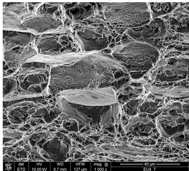
*EU<sub>4</sub>* sens T (1000x)FIGURE 1.48 – Observations au MEB des faciès de ruptures des éprouvettes *EU<sub>4</sub>*
