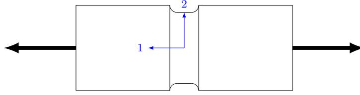
FIGURE 3.2 – Repère propre d'une éprouvette  $DP$  soumise à un effort de traction
