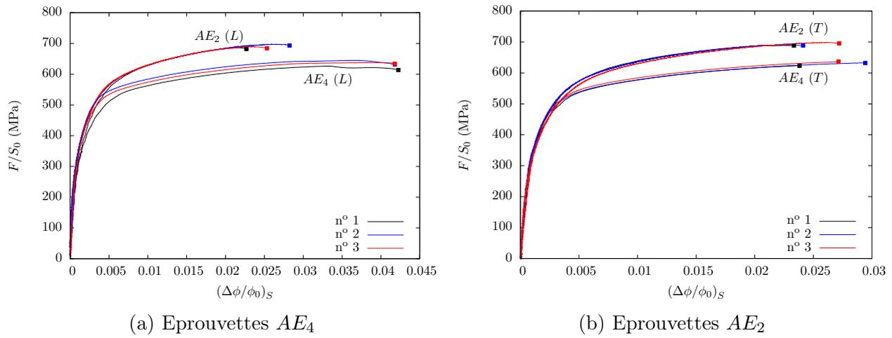
FIGURE 1.17 – Courbes contrainte–déformation diamétrale selon le sens  $S$  pour  $AE_4$  et  $AE_2$
