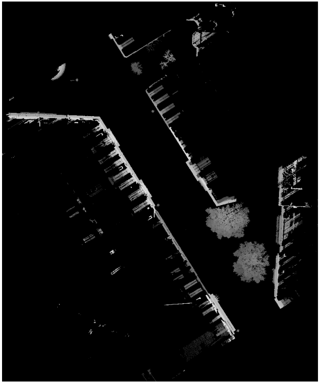
(d) Rue d'Assas: upper slice elevation image: points higher than H_{\text{slice}} .
