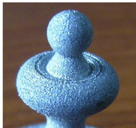
**Figure 1.16** – Pion d'échec fabriqué par SLM.
