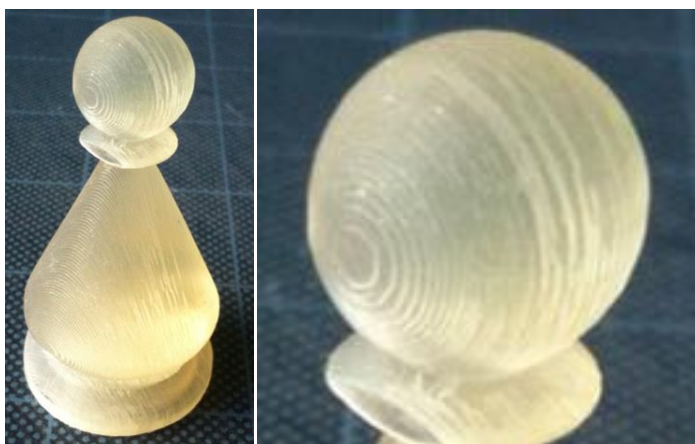
Figure 1.15 – Pion d'échec fabriqué par LOM. La fiche de données du constructeur donne l'épaisseur de la couche à 0,15 mm. [FLA09]
