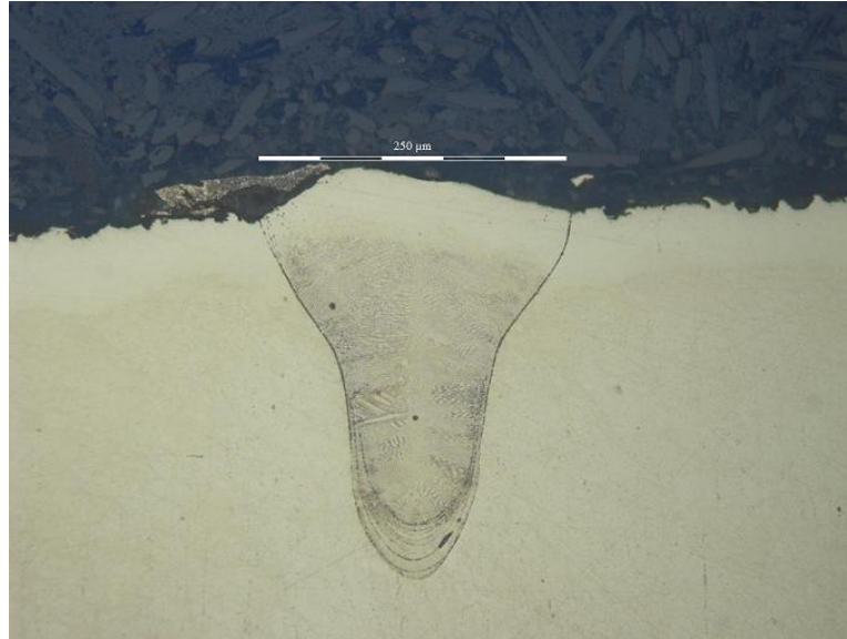
Figure 3.12 – Cordon présentant la forme caractéristique d’une absorption du faisceau par le mode en trou de serrure et justifiant l’appellation (irradiation sur Inconel 738). La largeur du cordon est d’environ 250 \mu\text{m} et sa profondeur est d’environ 300 \mu\text{m} .
