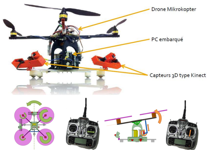
FIGURE 1.2 – Notre drone hybride à l'étude dans cette thèse.
