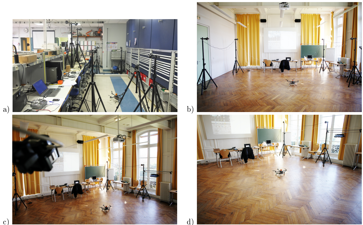
FIGURE 5.50 – Photos des différentes salles d'expérimentation équipées du système de Motion Capture. Les tests réalisés pour la procédure d'identification du modèle ont été effectués dans la salle de la figure a) ; quant aux tests de suivi de trajectoire, ils ont été menés dans la salle des figures b), c) et d). La nature très différente des sols entre l'identification et le suivi participe aux perturbations subies par le contrôleur, et donc à l'inexactitude du modèle.
