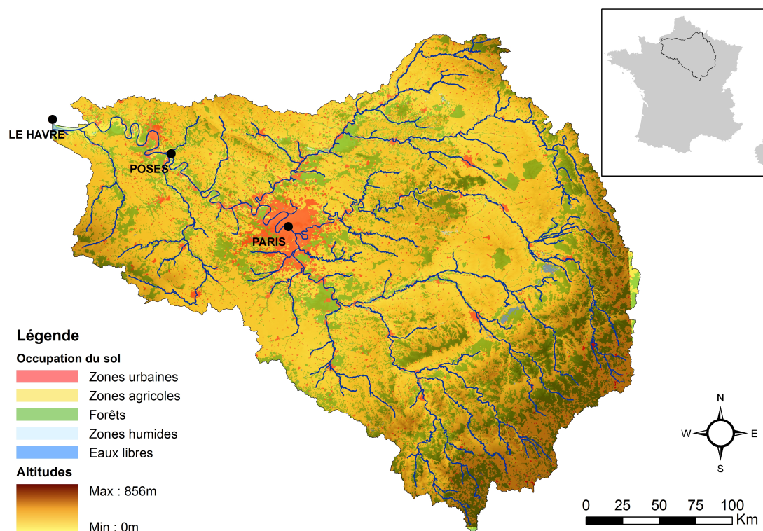
FIGURE 1.1 – Topographie, occupation des sols et réseau hydrographique du bassin versant de la Seine
