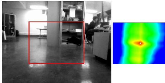
FIGURE 3.11 – Exemple d’auto-corrélation (modèle et maximum de corrélation en rouge) Plateforme utilisée : NAO
