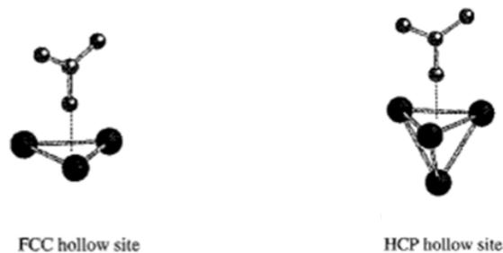
Figure C.6: Schéma des positions *Hollow FCC* et *Hollow HCP* et l'adsorption d'une molécule trigonale plane sur ces sites [120].
