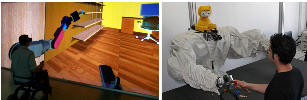
FIGURE 2.26 – Tests utilisateurs pour l'évaluation d'un prototype de fauteuil roulant avec bras robotisé [ De Santis et al., 2008 ] et l'échange d'objets entre un robot et un utilisateur [ Huber et al., 2008 ]
