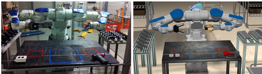
FIGURE 7.17 – La cellule expérimentale de collaboration homme-robot en situation réelle et en situation virtuelle
