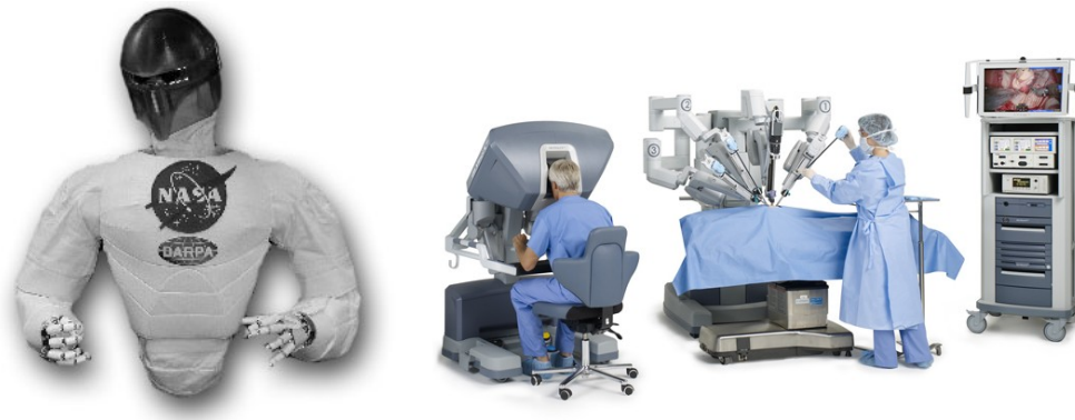
FIGURE 2.6 – Le Robonaut pour l'exploration spatiale [Glassmire et al. , 2004] et le robot DaVinci pour la chirurgie téléopérée
