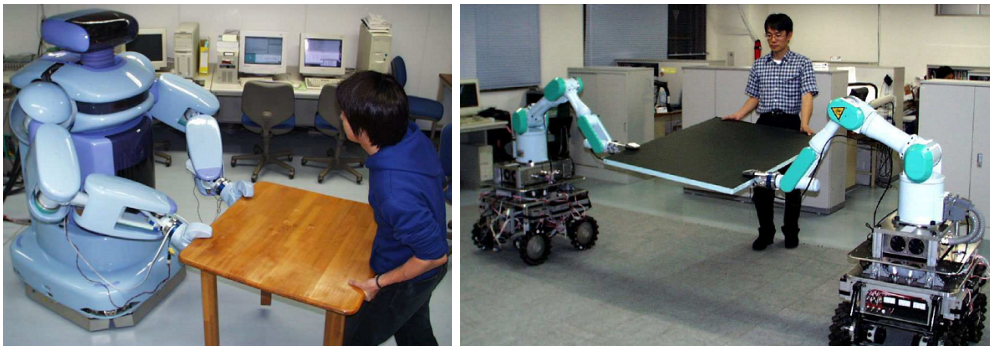
FIGURE 2.7 – Les robots MRHelper [Kosuge et al. , 2000] et DRHelper [Hirata et Kosuge, 2000] pour la comanipulation d'objets
