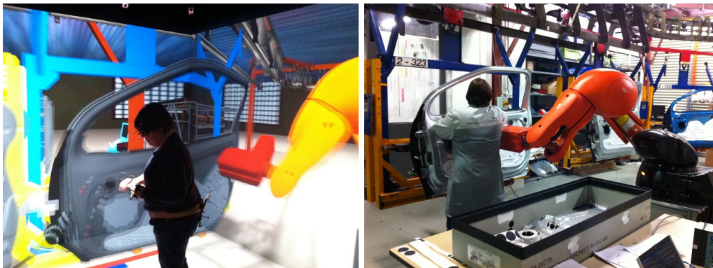
FIGURE 1.7 – Comparaison du comportement d'un opérateur en situation virtuelle (à gauche) et en situation réelle (à droite)
