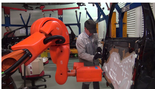
FIGURE B.1 – Le poste de montage de porte en coprésence avec un robot
