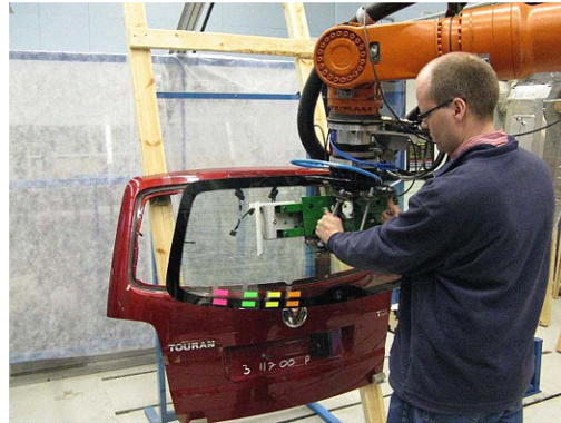
FIGURE 2.4 – Un IAD pour la pose de vitres pour le projet PiSA [Koskinen et al. , 2009]
