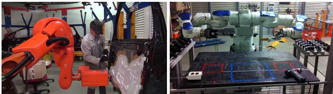
FIGURE 8.6 – Les expérimentations sur les facteurs liés à la configuration de collaboration : la distribution spatiale et la distribution temporelle de l'opérateur et du robot
