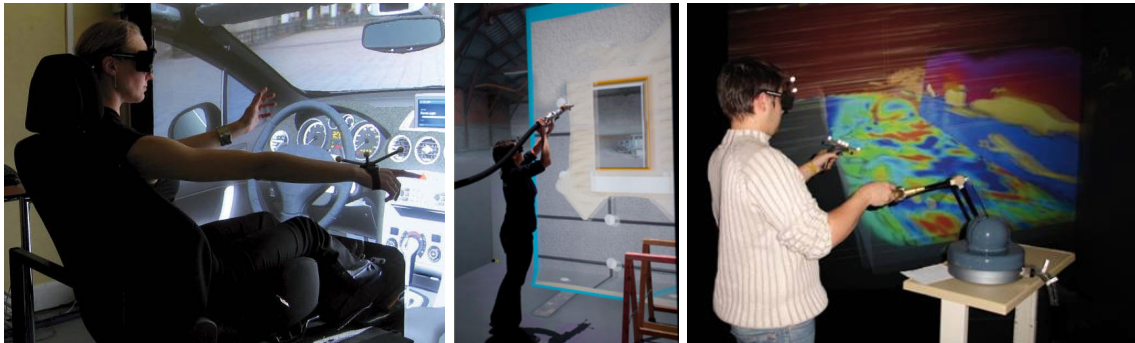
FIGURE 3.4 – Des exemples d'applications de la réalité virtuelle : un simulateur de conduite (MINES ParisTech), une formation à la technique de projection d'enduit de façade de bâtiment (Clarté) et une exploration de dynamique des fluides (Limsi).
