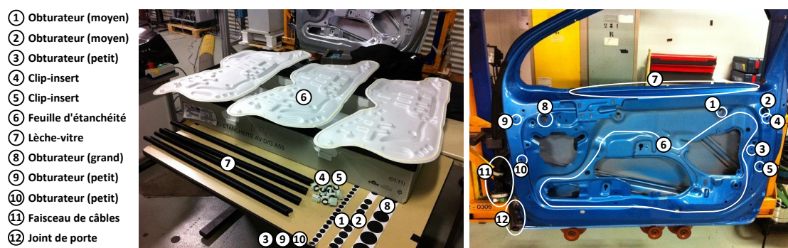
FIGURE 6.7 – L'ordre des opérations à effectuer, les pièces correspondantes et leur emplacement sur la porte
