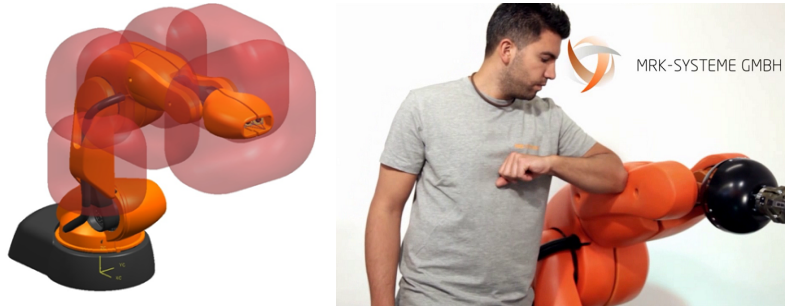
FIGURE 6.5 – La zone de détection autour du robot et l'arrêt instantané du robot lors d'une collision avec un opérateur
