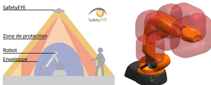
FIGURE 1.3 – Le système de supervision SafetyEYE à base de caméras et le robot Kuka KR5SI dotés de ses capteurs détectant une proximité humaine
