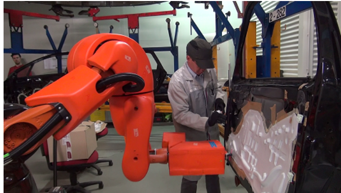
FIGURE 6.3 – Le poste de pose de feuille d'étanchéité en coprésence avec un robot (cellule expérimentale)
