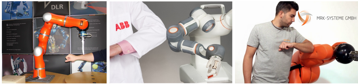
FIGURE 2.24 – Le robot Kuka LWR (structure mécanique détectant les collisions) [Haddadin et al. , 2011], le robot ABB Frida (mousse protectrice et détection des collisions) et le robot Kuka KR5-SI (mousse protectrice dotée de capteurs tactiles et capacitifs)
