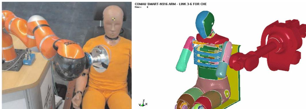
FIGURE 2.25 – Evaluation de la sécurité des robots par crashtest [Haddadin *et al.*, 2007] et simulation par éléments finis [Oberer et Schraft, 2007]
