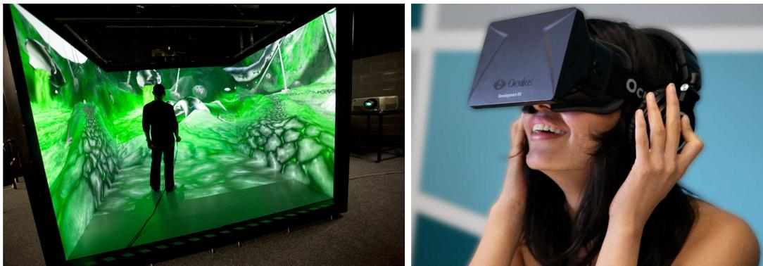
FIGURE 3.3 – Un utilisateur dans un système de type CAVE (Christie, à gauche) et un utilisateur portant un casque de réalité virtuelle (Oculus Rift, à droite)
