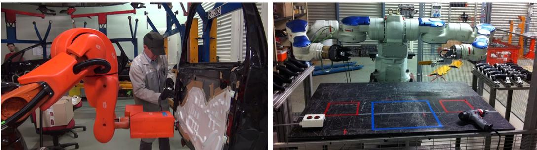
FIGURE 8.6 – Les expérimentations sur les facteurs liés à la configuration de collaboration : la distribution spatiale et la distribution temporelle de l'opérateur et du robot
