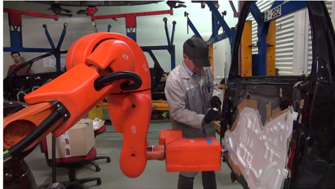
FIGURE 4.2 – Le premier cas d'étude mis en place par PSA Peugeot-Citroën : montage de porte en coprésence avec un robot
