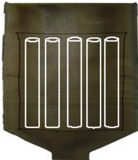
Figure III-1 : Lopin de poudre ODS consolidée par filage à chaud : prélèvements des éprouvettes de torsion par électroérosion.
