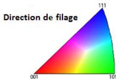
Figure II-16 : Code couleur utilisé pour les cartographies EBSD représentées dans cette section.
