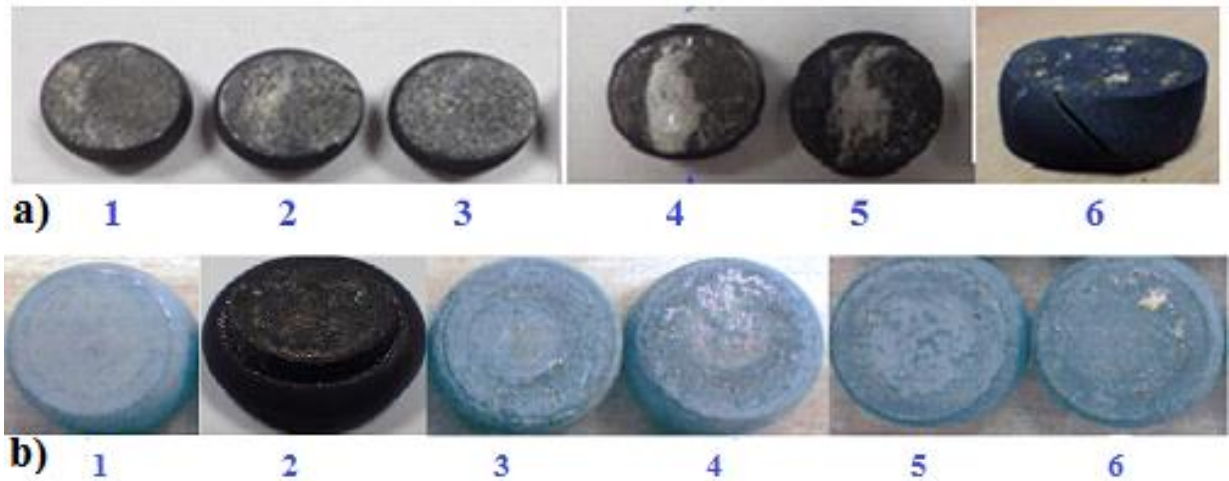
Figure III-10 : Aspects des échantillons comprimés : a) Nuance ODS de référence, et b) Nuance non renforcée.
