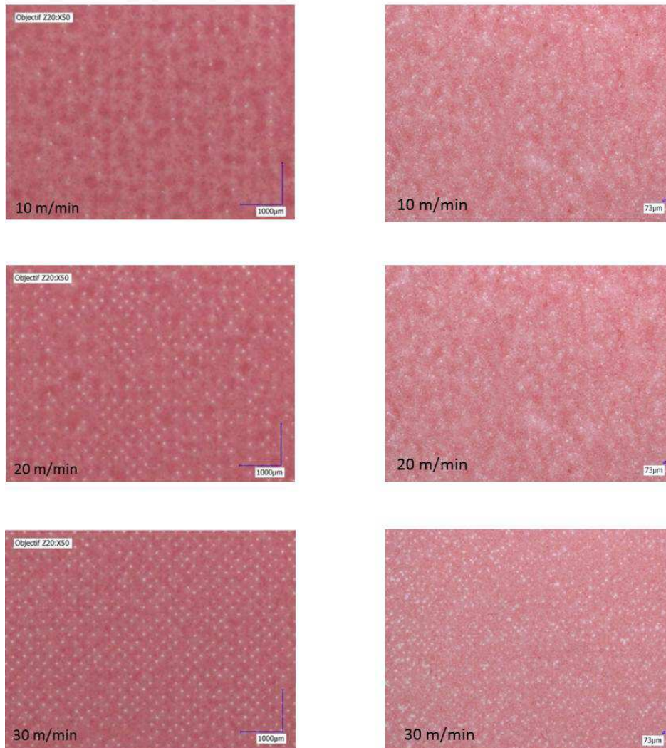
Figure 4-1 - Influence de la vitesse d'impression sur la qualité d'impression, avec des supports calandré et enduit
