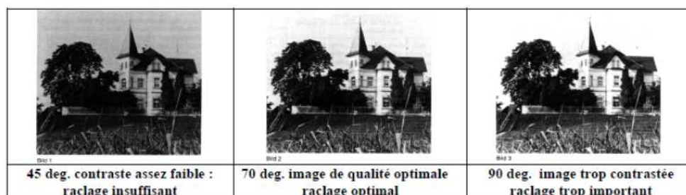
Figure 2-34 - Influence de l'angle de raclage sur la qualité d'impression (Boissonnet, 2007)
