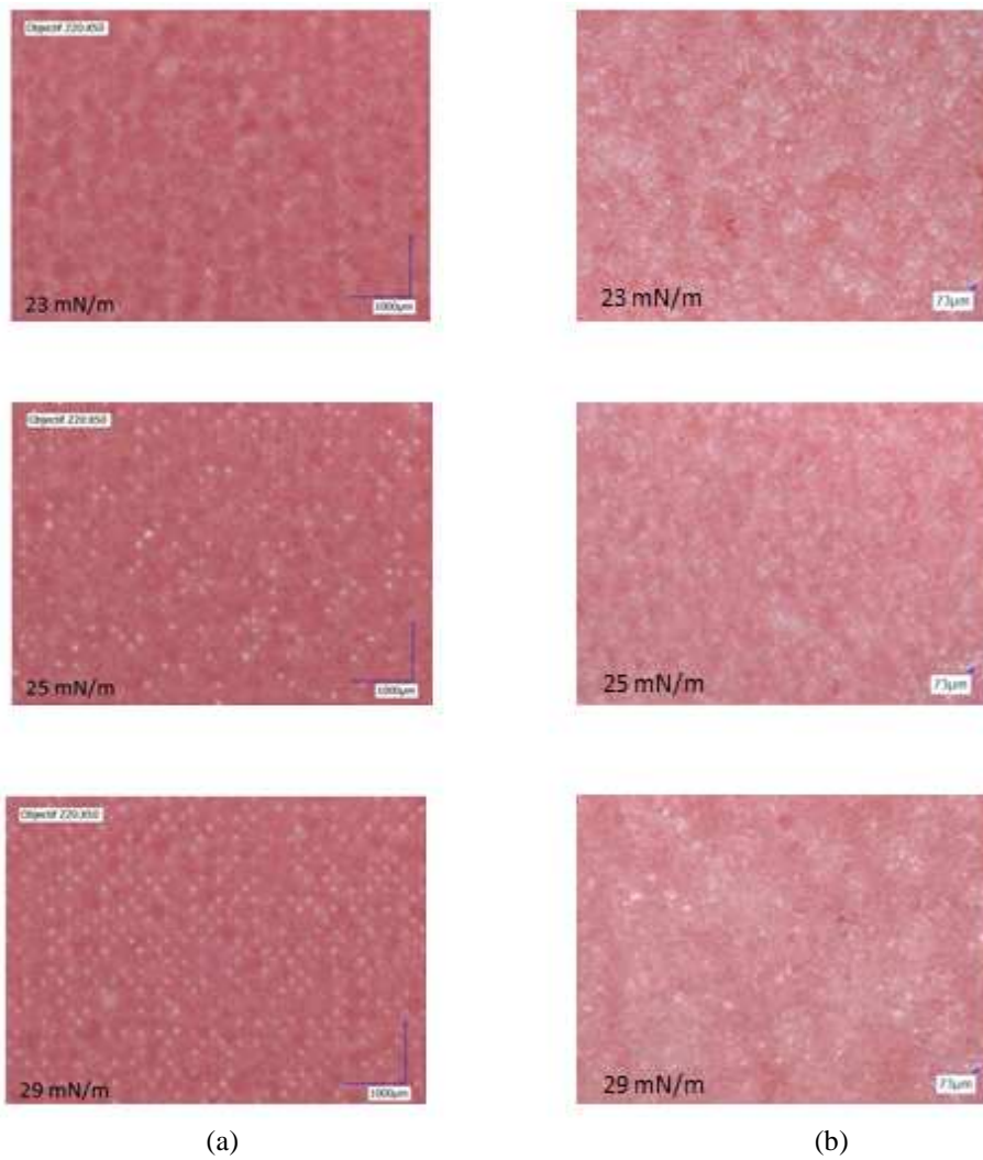
Figure 4-40 - Influence de la tension de surface sur la qualité d'impression, avec des supports calandré (a) et enduit (b)
