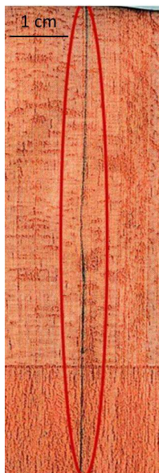
Figure 1-13 - Défaut de ligne d'impression (écoulement d'un agrégat d'encre) sur un film PVC calandré
