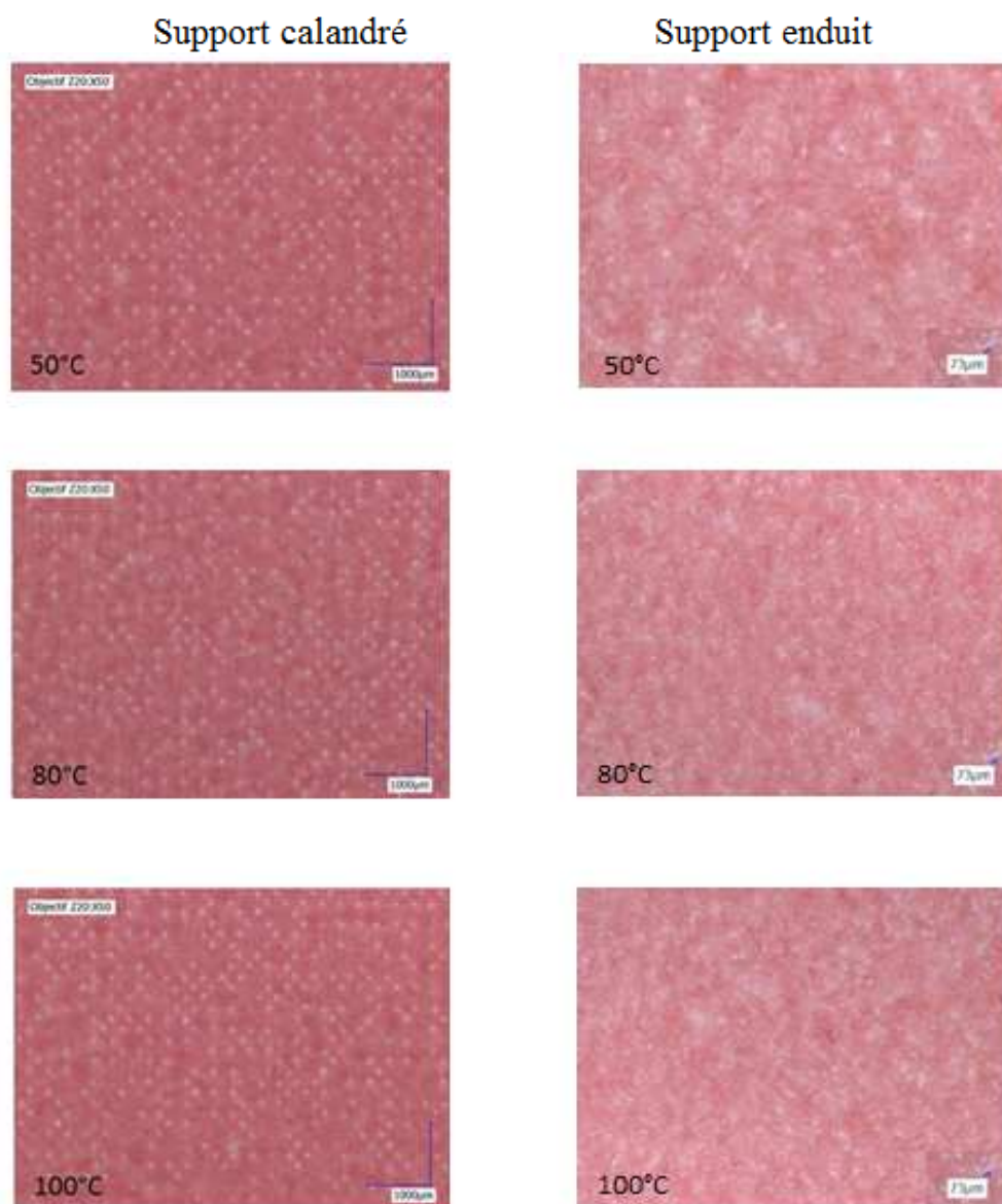
Figure 4-21 – Influence de la température de séchage sur la qualité d'impression, avec des supports calandré et enduit
