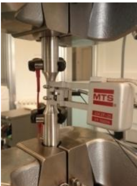
Figure II.7 : Machine de fatigue MTS et extensomètre fixé sur la partie utile, pour piloter en déformation.
