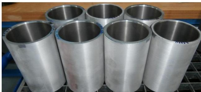
**Figure 2. 8.** Chemises bi-matière issues de carter-cylindre H5 en aluminium
