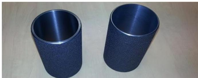
**Figure 2. 5.**Type de chemises utilisées (à droite : chemise après pré-usinage ; à gauche : chemise brute de fonderie)
