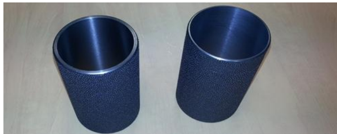
Figure 2. 5. Type de chemises utilisées (à droite : chemise après pré-usinage ; à gauche : chemise brute de fonderie)
