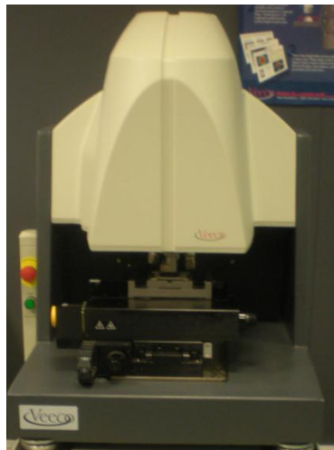
Figure 2. 12. Interféromètre Veeco pour mesure de la topographie 3D
