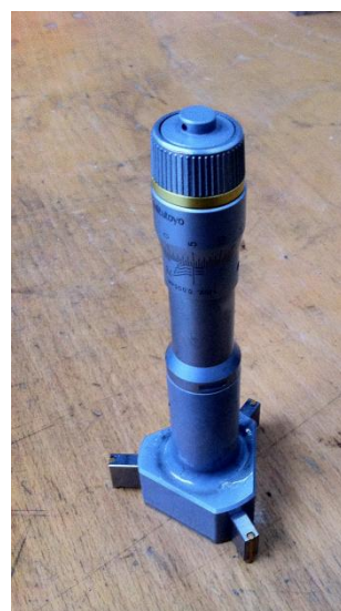
Figure 2. 9. (a) Vérificateur d'alésage, (b) micromètre d'intérieur à trois touches
