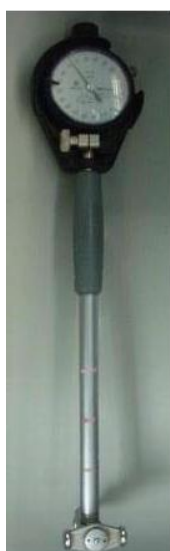
Figure 2. 9. (a) Vérificateur d'alésage, (b) micromètre d'intérieur à trois touches
