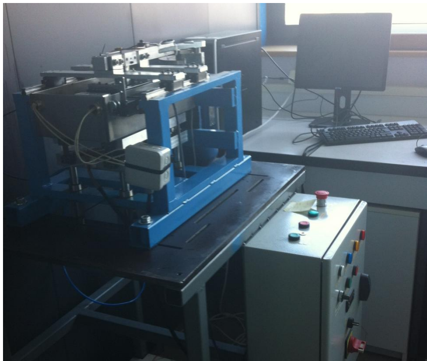
Figure 2. 14. Vue d'ensemble du tribomètre
