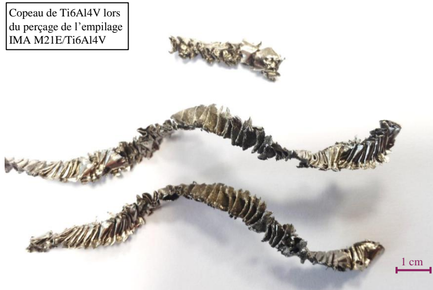
Figure 135 : Morphologie du copeau de Ti6Al4V lors du perçage de l'empilage IMA M21E/Ti6Al4V
