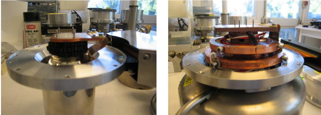
FIGURE 3.2 – Cryostats à bain d'azote : GRAU à gauche et STGRAU à droite.
