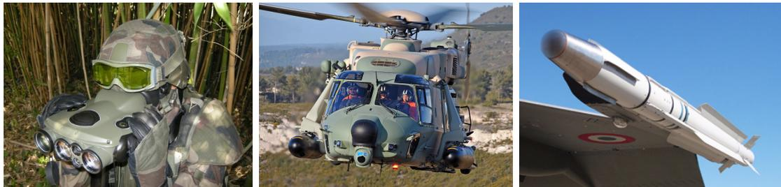
FIGURE 1.16 – Exemples d’applications militaires de la détection infrarouge : à gauche, jumelles de vision nocturne portable Sagem Jim LR (détecteurs MWIR refroidis) ; au centre, hélicoptère NH90 équipé d’une « boule optronique » Euroflir™ 410 de Sagem ; à droite, autodirecteur infrarouge bispectral du missile MICA monté sur un Rafale (crédits Sagem).
