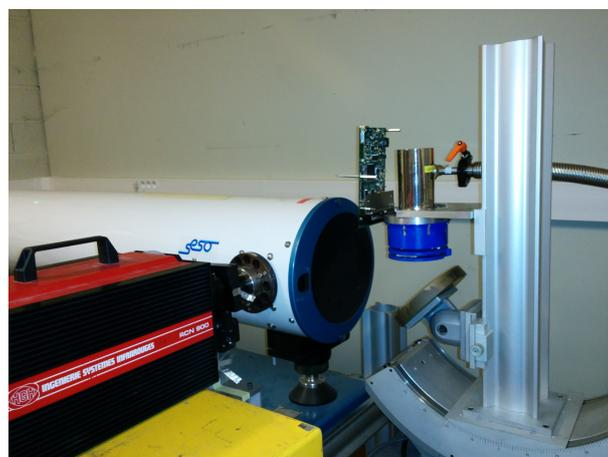
FIGURE 3.57 – Photographie du banc optique pour la mesure de la fonction d'étalement de ligne de la caméra à détecteurs courbes.
