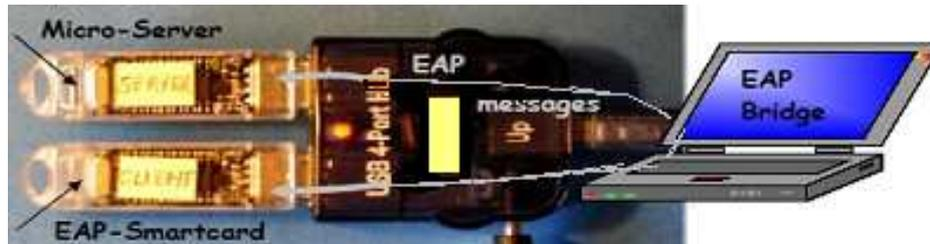
figure 7-2 : micro-serveur et client EAP insérés chacun dans un lecteur USB de cartes à puce.
