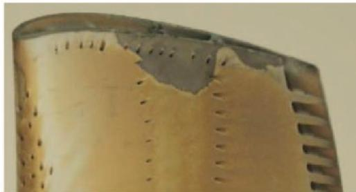
FIGURE 6.37 – Début d'écaillage d'une aube [Vaunois 2013a].
