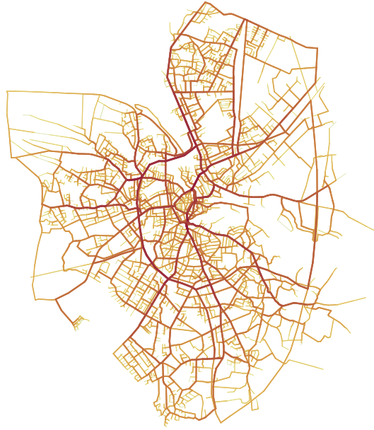
FIGURE 5 – Jeu de données composé de 10000 trajectoires en mobilité sur le réseau routier de la ville d'Oldenburg. Les segments routiers sont coloriés en fonction de leur taux d'utilisation (nombre de trajectoires les ayant fréquentés) : une couleur jaune pale indique un segment peu fréquenté, alors qu'une couleur rouge foncée indique un segment très fréquenté.
