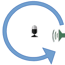
Figure 2.2 – Mesure de directivité. Les mesures se font ici tous les 10^\circ
