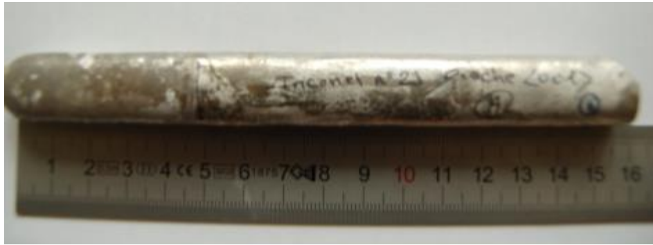
Figure 3.6. Image du barreau de l'Alliage 600 monocristallin
