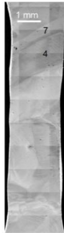
Figure A3.23. Cartographie MEB (EP1406-2 face B). Déformation macroscopique de 10%
