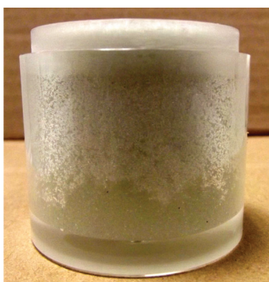
FIGURE 3.31 – Photographie de l’échantillon (1% d’agent de réticulation - \zeta = 0.9 ) à la fin de l’expérience après plus de 4 jours de séchage (112 heures). A environ 1 centimètre du fond, le net changement d’indice optique du milieu poreux indique le front de désaturation. Le bas de l’échantillon est complètement saturé en liquide.
