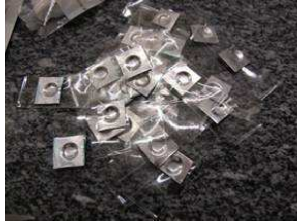
(b) Quelques cibles poinçonnées, attendant de recevoir un dépôt.
