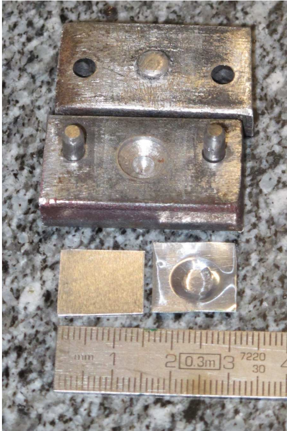
(a) Poinçonneur, une cible découpée et une autre enfoncée.
