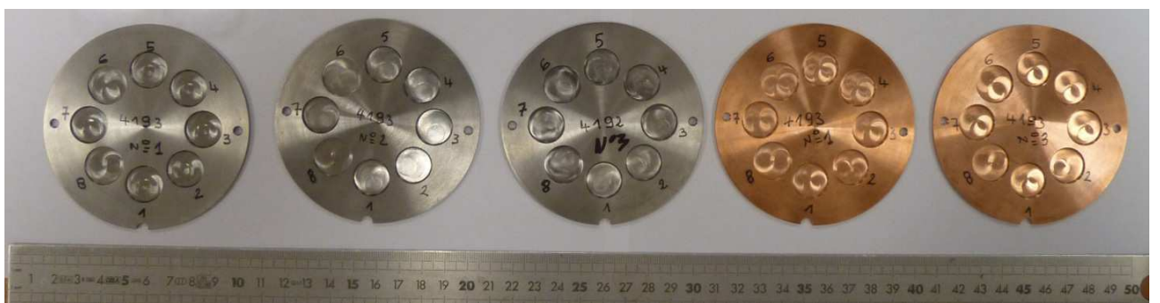
FIGURE 5.11 – Photographie des « transmetteurs 2 » utilisés dans les expériences « Lanceur de particules ». Leur diamètre est de 9,0 cm. Les 8 lamages de diamètre 15 mm et de profondeur 1,0 mm, sont disposés sur un cercle de diamètre 5,0 cm. Les lamages possèdent un chanfrein destiné à adoucir les angles, à l'exception des emplacements n° 6 et 8 qui sont piqués (c'est-à-dire, présentant un bord droit), afin de permettre l'insertion d'une cible d'étain (figure 5.12).
