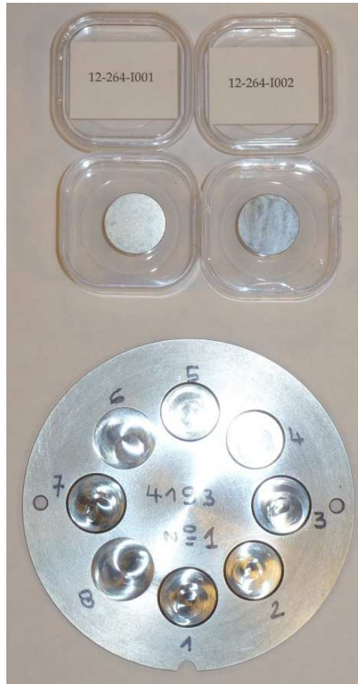
FIGURE 5.12 – Photographies de cibles étain et d'un transmetteur en Dénal.
