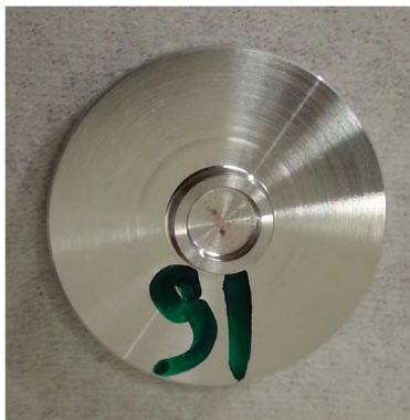
(a) Cible possédant un très faible dépôt de poudre, cependant suffisant pour être observé.
