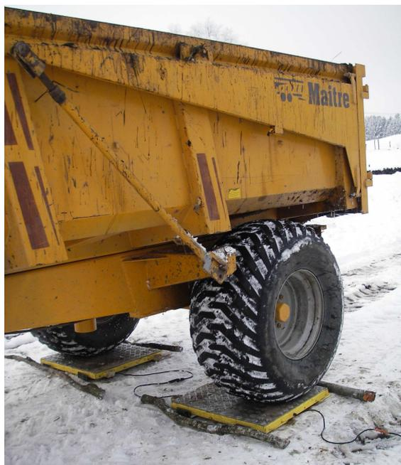
Les rampes de montée et descente des roues n'étant pas systématiquement présentes, les rondins de bois servaient éventuellement à faciliter la montée des roues sur les pesons et à éviter tout glissement non désiré du matériel malgré leur poids important. Une forte capacité d'adaptation était donc nécessaire lors de ces suivis.
