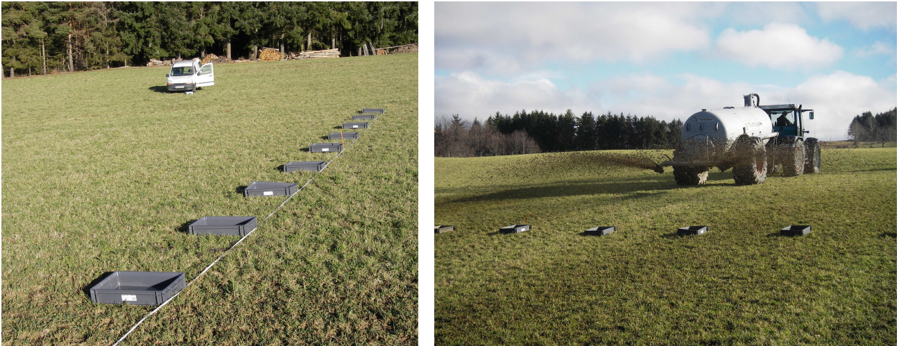
Figure 3.3 : Mesure de la régularité transversale de l'épandage du lisier chez Li03 (B. Janichon)
