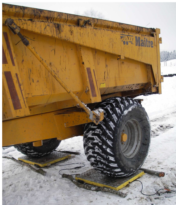
Figure 3.2 : Pesée de l'essieu de la benne de transport du fumier en conditions enneigées (B. Janichon)
