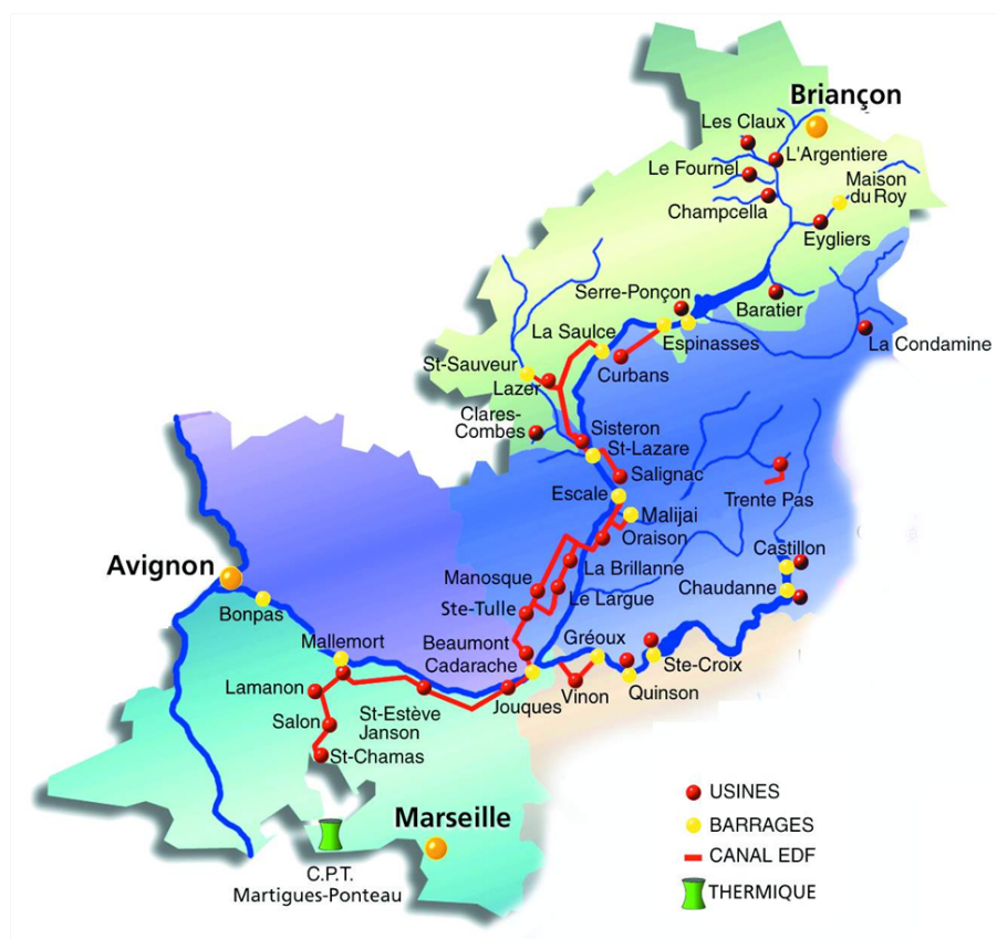
Figure 1.19 – Aménagements hydroélectriques de la Durance (Source : EDF).
