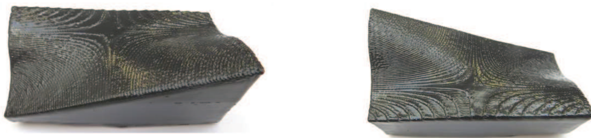
Figure 104 - Effets de l'acétone sur une surface présentant un effet d'escalier
