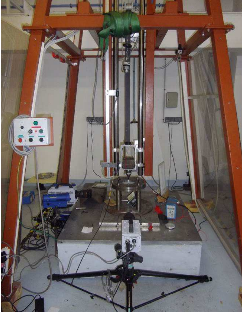
FIGURE A.4 – Photographie de la tour de chute instrumentée.
