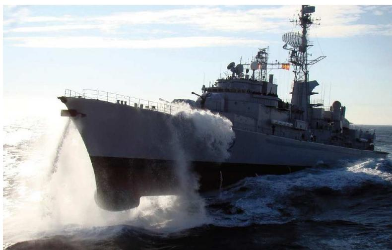
FIGURE 1.5 – Exemple de tossage d'un bateau [Tassin 2010].
