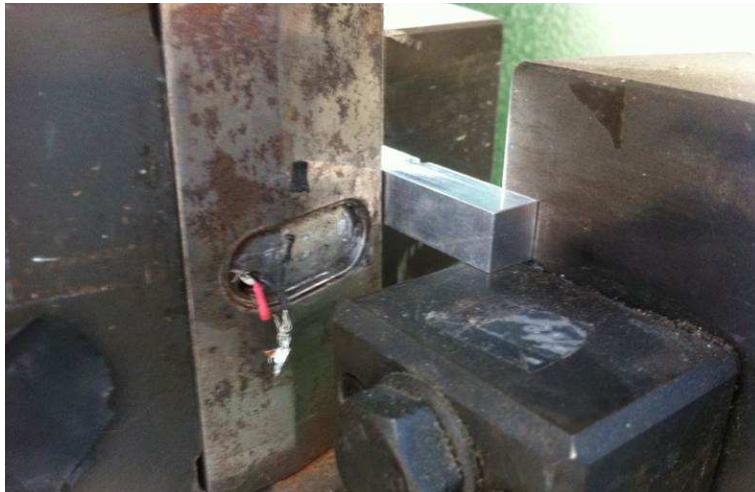
FIGURE C.4 – Positionnement du marteau de l'essai Charpy par rapport à l'éprouvette.
