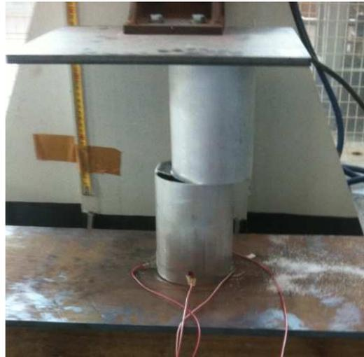
FIGURE 4.36 – Tube après l'impact pour le flambage asymétrique.
