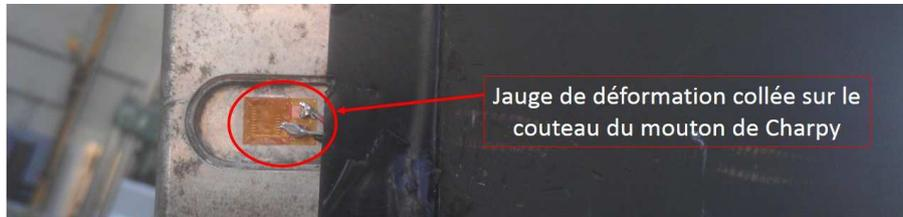
FIGURE C.3 – Jauges de déformations positionnées sur le couteau.
