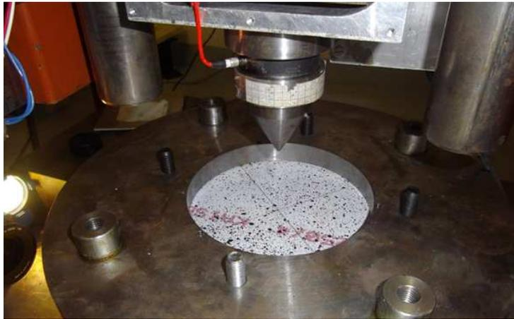
FIGURE A.3 – Photographie de l'outillage de serrage la plaque.
