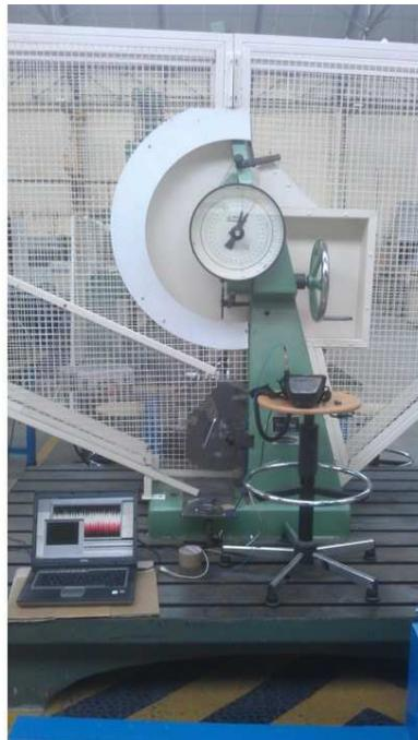
FIGURE C.1 – Banc d'essai du pendule-mouton de Charpy.
