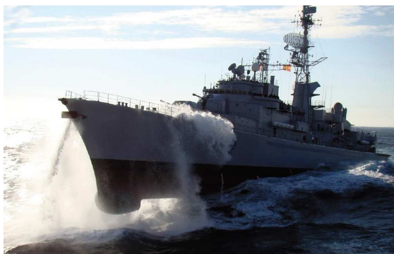
FIGURE 1.5 – Exemple de tossage d'un bateau [Tassin 2010].
