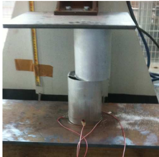
FIGURE 4.36 – Tube après l'impact pour le flambage asymétrique.
