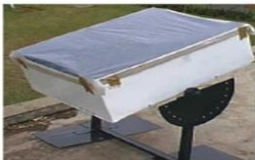
Fig. 1.14 Séchoir à inclinaison variable (Gikuru et al ,2005).
