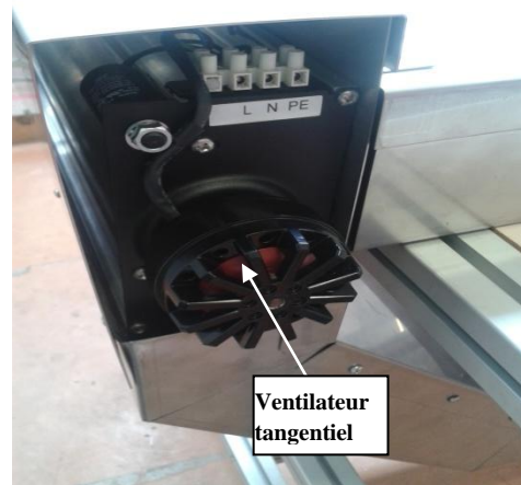
Fig. 3.36 Introduction du ventilateur dans la conduite d'air
