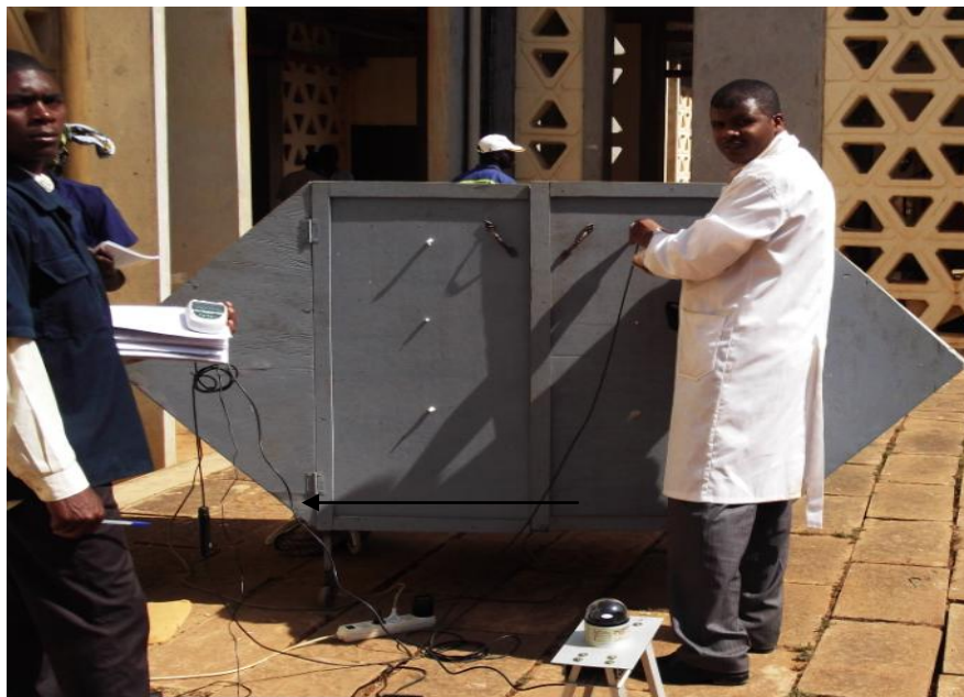
Fig. 4.20 Mesure des paramètres de l'air intérieur du séchoir.
