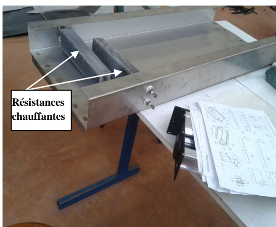
Fig. 3.37 Fixation des résistances chauffantes dans la conduite d'air
