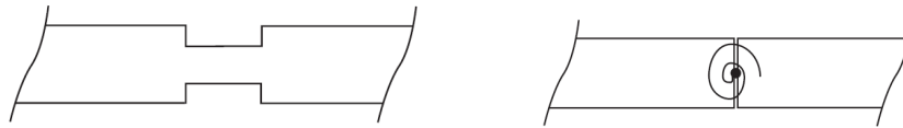
(a) Réduction de la rigidité EI dans la zone influencée par la fissure (b) Ressort de tension à l'endroit de la fissure
