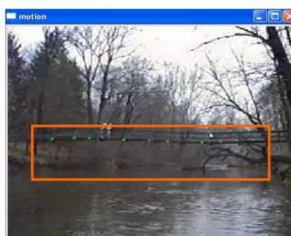
FIGURE 8.10 – Exemple d'estimation du mouvement. Les 10 points à corrélérer sont en vert et la zone à étudier est celle qui est dans le cadre orange
