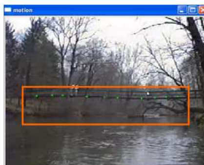
FIGURE 8.11 – Exemple d'estimation du mouvement. Les 10 points à corrélérer sont en vert et la zone à étudier est celle qui est dans le cadre orange
