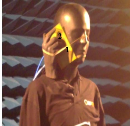
Figure 4.32: Positionnement du système antennaire à base de méandres en présence de KEVIN et de la main.
