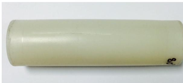
Figure 167 - Tuyau éclaté sous pression hydrostatique de 37 bars à 80°C
