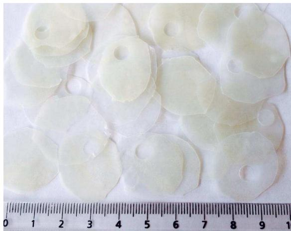
Figure 65 - Disques de matrices PA66 stabilisée chargée
