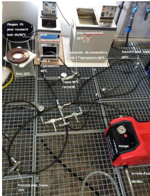
Figure 87 - Montage de l'essai de pression hydrostatique au CSTB de Nantes
