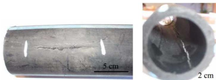
**Figure 6 - Tube fissuré provenant d'un site désinfecté au DOC (Devilliers, 2011)**
