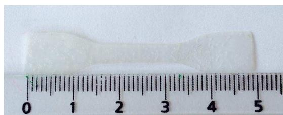
Figure 66 - Haltère de matrice PA66 stabilisée chargée
