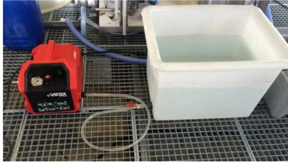
Figure 86 - Réserve d'eau distillée et pompe de mise sous pression au CSTB de Nantes
