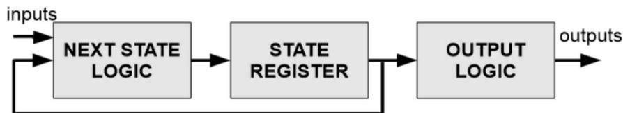
FIG. 2 – Schéma d'un circuit numérique avec ses parties séquentielles et combinatoires.
