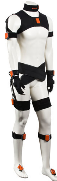
FIGURE 1.2. Système corps entier de centrales inertielles non-filaires (source : www.xsens.com ).
