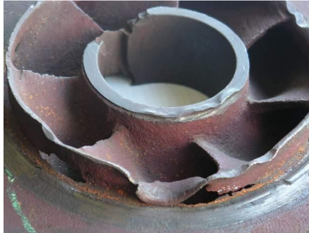
Figure I-2 Pompe centrifuge endommagée par la cavitation.
