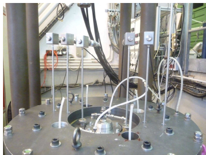
j – installation des capteurs de pression interstitielle
