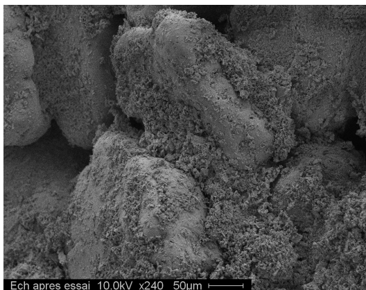
Figure 3-4 - Analyse du cake interne formé au cours de l'injection des particules - Observations au microscope électronique à balayage (MEB) sur le même échantillon à différents grossissements. (essai N1 ; NE34, d_p = 6 \mu\text{m} , C = 0,2 \text{ g/l} , Q = 4 \text{ cm}^3/\text{s} )
