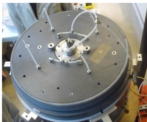
Figure 2-27 – Vue de l'embase supérieure mise en place sur le massif
