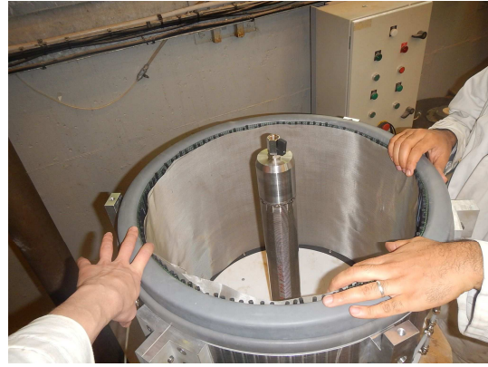
Figure 2-26 – Vue du système de drainage périphérique
