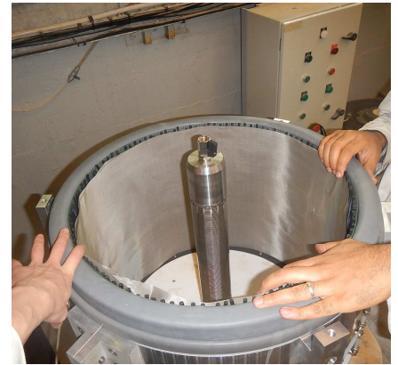
c – mise en place du dispositif de drainage périphérique
