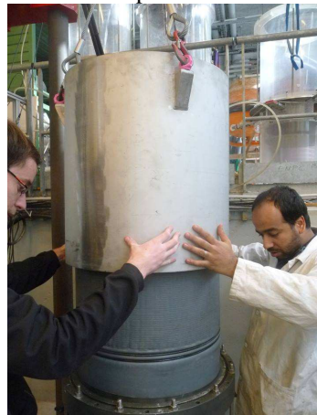
h – mise en place de l'enceinte de confinement latéral
