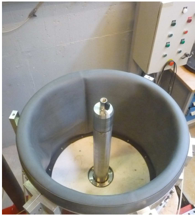
b – mise en place de la membrane de confinement latéral
