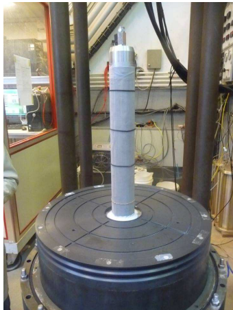
a – mise en place de la crépine
