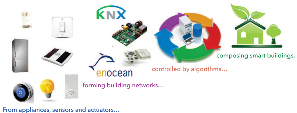
Figure 6.1: Une série d'étapes sont nécessaires avant que des économies d'énergie et une amélioration du confort puissent être obtenus dans les bâtiments intelligents. Les algorithmes de contrôle s'appuient sur les fonctionnalités offertes par les réseaux de bâtiments, eux-même composés d'objets intelligents. Ces objets peuvent être de l'électroménager, des composants multimédias tels que TV et radio, ainsi que des capteurs et des actionneurs.
