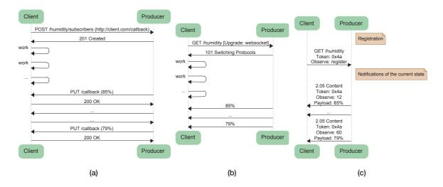
**Figure 6.6:** Diagrammes de séquences utilisant HTTP et CoAP. (a) le HTTP callback transforme le client en un serveur exposant une ressource de rappel. (b) HTTP est uniquement utilisé pour initier une WebSocket qui va se transformer en une connexion TCP bi-directionnelle. (c) les clients peuvent observer et être notifiés par une réponse CoAP contenant la nouvelle représentation.
