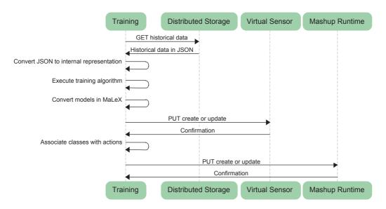
Figure 6.15: La phase d'entraînement de l'apprentissage automatique est positionné au dessus des autres niveaux. Les données historiques des capteurs et actionneurs vont être récupérées à partir du stockage distribué à l'intérieur du réseau de capteurs. Après avoir entraîné les modèles, ceux-ci peuvent être déployés comme Capteur Virtuels et Classes Virtuelles. De plus, la phase d'apprentissage peut également automatiquement définir des scénarios de contrôle sous forme de mashups.
