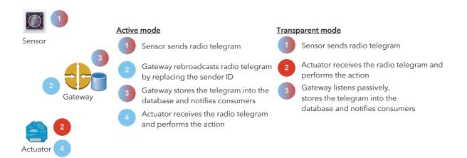
**Figure 6.18:** La passerelle intelligente EnOcean peut fonctionner dans deux modes d'opération. Dans le mode actif, la actionneurs seront uniquement pairés avec la passerelle. Dans le mode transparent, la passerelle ainsi que les capteurs sont pairés avec les actionneurs.
