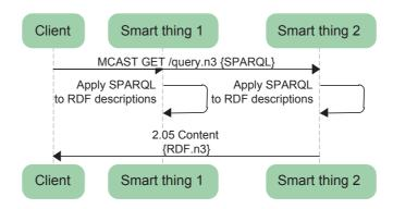
**Figure 6.9:** Les clients émettent leurs requêtes SPARQL sur un groupe multicast prédéfini. Chaque objet intelligent dans le réseau vérifie s'il possède des ressources RDF correspondantes et répondra uniquement dans ce cas.
