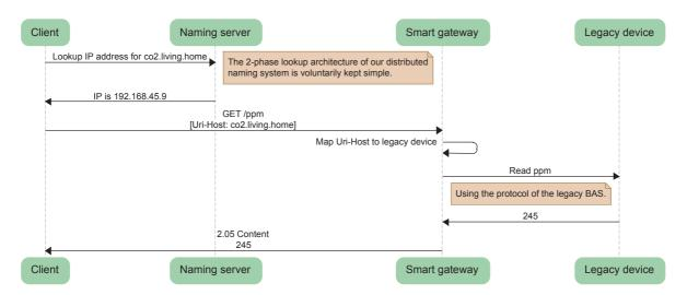
Figure 6.11: Les clients utilisent les mêmes concepts d'interaction avec les dispositifs connectés à des réseaux d'automatisation classiques. La requête sera cependant traitée par une passerelle intelligente faisant la correspondance entre Uri\_Host et une adresse. Après avoir communiqué avec le dispositif, la passerelle retournera le résultat dans la réponse HTTP ou CoAP.
