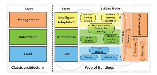
**Figure 6.7:** Comparaison entre l'architecture en couches classique de l'automatisation du bâtiment et notre contribution du Web des Bâtiments. Chaque couche peut fonctionner indépendamment et est composée d'une série de blocs facilitant le développement d'applications pour les bâtimenrs intelligents.
