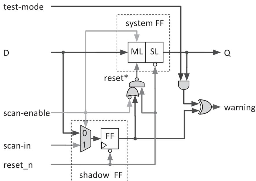
FIGURE 2.3 – Bascule *shadow-scan* à contrôlabilité totale.
