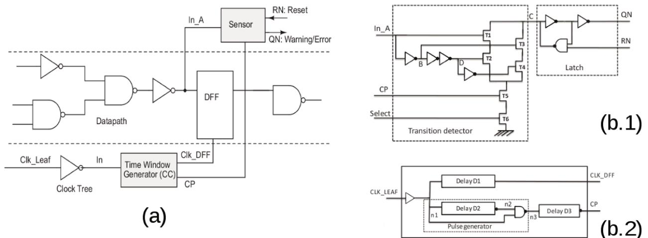
FIGURE 1.10 – Exemple de solution de détecteur de transitions (a) et détails d'implémentation du *Sensor* (b.1) et du *Time Window Generator* (b.2) [RBB<sup>+</sup>11].
