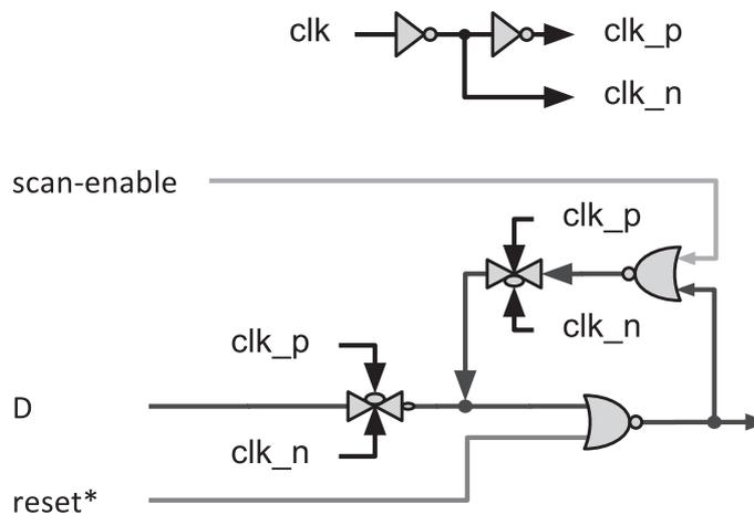
FIGURE 2.4 – Détail du *master-latch* (ML) amélioré de la bascule fonctionnelle.
