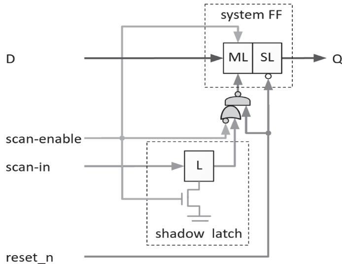
FIGURE 3.5 – Bascule *shadow-scan* avec *power-gating*.
