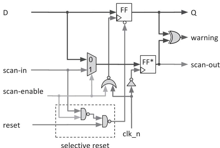
FIGURE 2.1 – Bascule *shadow-scan* à contrôlabilité partielle.
