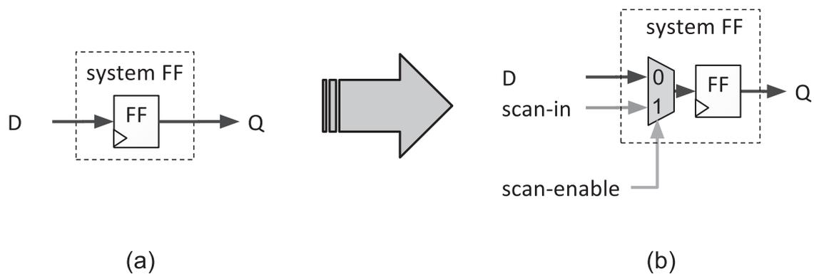
FIGURE 1.6 – Transformation bascule en bascule *standard-scan*.
