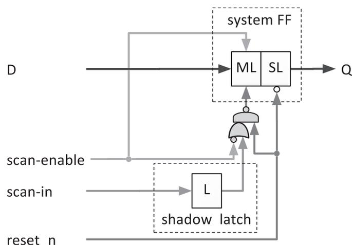
FIGURE 3.1 – Bascule *shadow-scan* pour le test uniquement.
