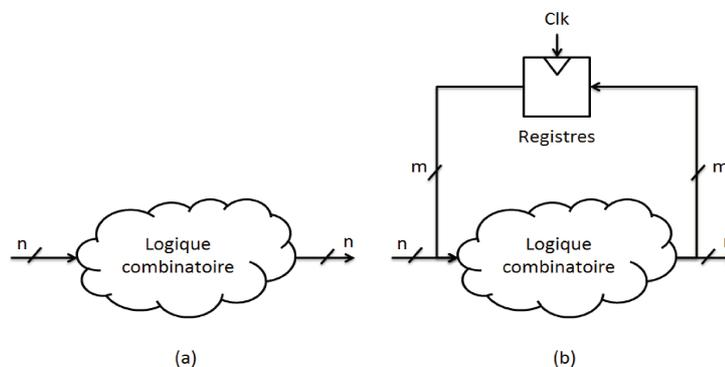
FIGURE 1.2 – Accroissement de la difficulté du test des circuits séquentiels vis-à-vis des circuits combinatoires.
