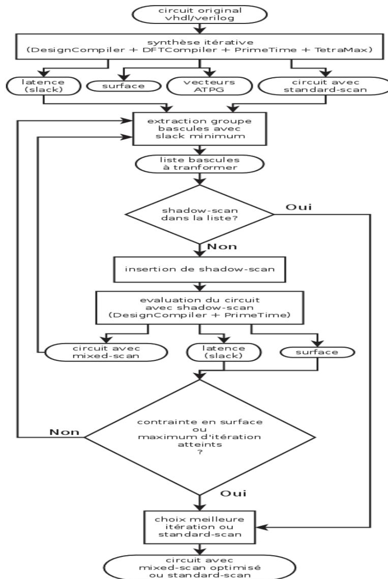
FIGURE 3.4 – Flot de déploiement des bascules *shadow-scan*.
