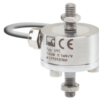
Figure 5.22: Capteur utilisé pour mesurer les efforts agissant dans chaque branche de l'éprouvette bi-axiale.
