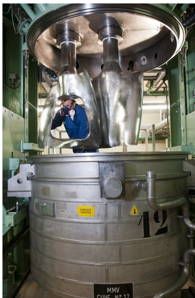
Figure 1.5: Phase de malaxage d'un chargement de propergol dans une cuve (d'après le site internet de SAFRAN HERAKLES)
