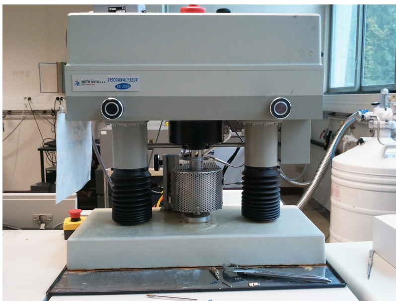
Figure 3.3: Viscoanalyseur Metravib utilisé pour réaliser les essais de DMA avec déformation statique
