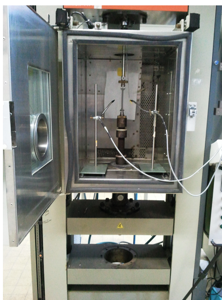
Figure 3.5: Machine de traction Zwick 1474 utilisée pour réaliser les essais de relaxation avec déformation statique.
