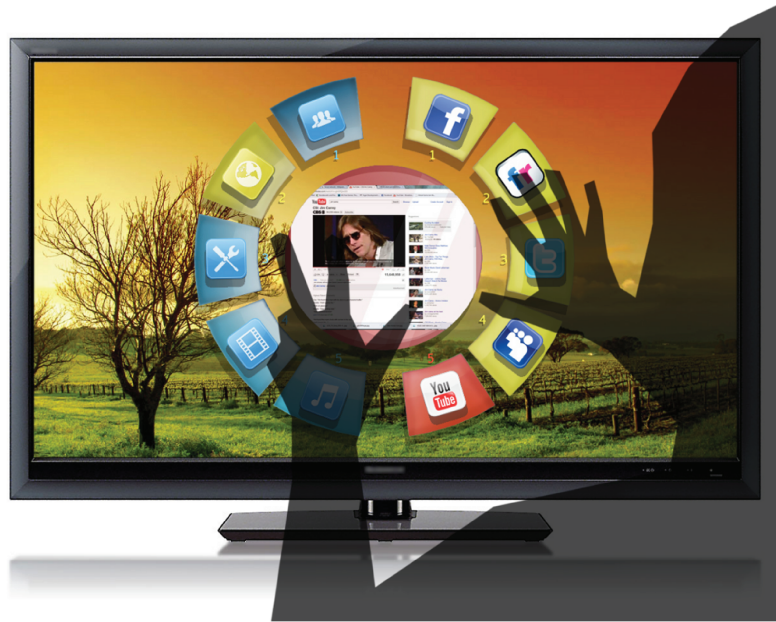
FIGURE 3.19: Finger Count : Montrer ses mains et un nombre de doigt au système permet de sélectionner un élément dans un menu affiché à distance sur la TV [Bailly et al. , 2011]
