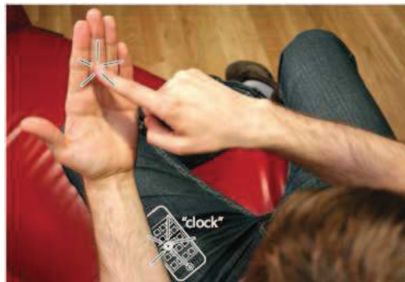
FIGURE 6.2: Imaginary Phone : l'utilisateur utilise la paume de sa main comme surface de substitution à son téléphone. Grâce à la mémoire spatiale, l'utilisateur exécute une commande sur son téléphone en touchant la paume de sa main [Gustafson et al. , 2011].
