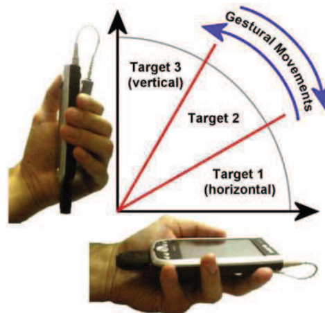
FIGURE 4.8: Orientation du geste : le geste permet d'incliner le téléphone dans une direction pour sélectionner un élément du menu [Oakley et Park, 2009].
