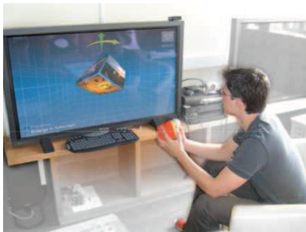
FIGURE 4.4: Un geste manipulateur : l'utilisateur manipule un cube physique pour explorer l'interface affichée sur l'écran [Block et al. , 2004].
