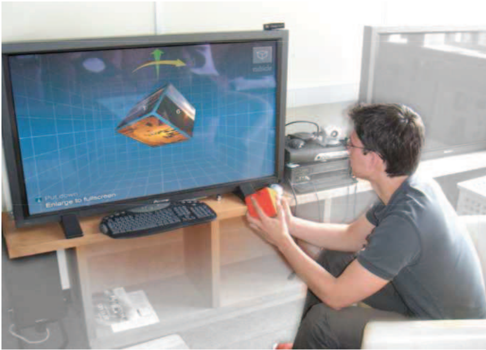
FIGURE 3.7: Un exemple de télécommande en forme de cube : le lien entre la forme de la télécommande et la représentation visuelle est très étroit [Block et al. , 2004].
