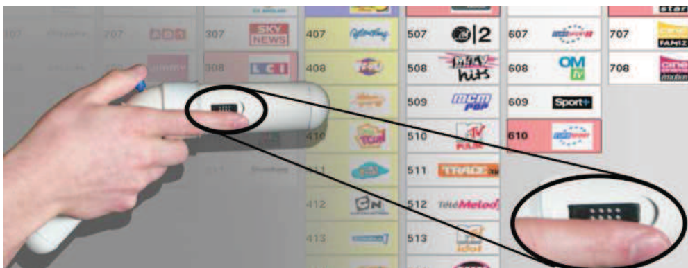
FIGURE 3.22: Tactimote : une cellule braille permet de transmettre de l'information par l'index. [Tahir et al. , 2008]
